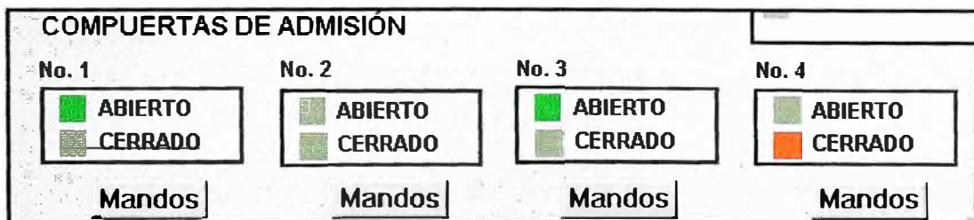
FIG. 3.20 POSICION Y MANDOS DE COMPUERTAS DE ADMISION
