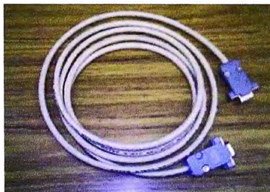
Figura A.4 Cable DB9 utilizado para comunicación serial entre la PC y el Equipo Registrador de Llamadas
