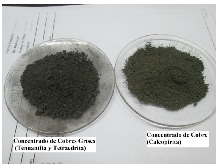
Figura 4.3: Fotografía de los productos de flotación
