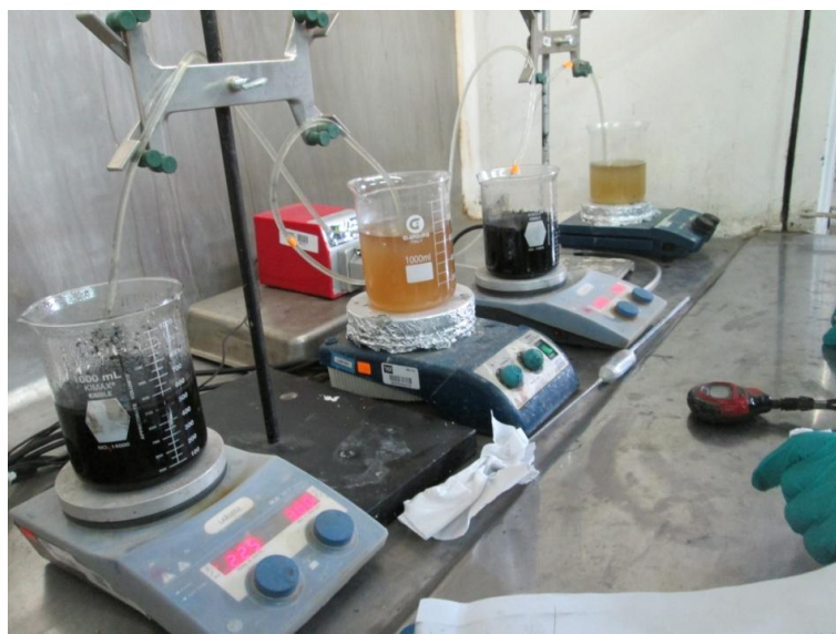
Figura 3.2: Fotografía del Sistema de Lixiviación Alcalina
