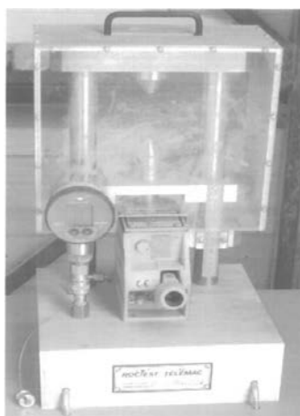
Figura 1.3: Equipo PLT Modelo PIL-7 utilizado para ensayo de carga puntual.
