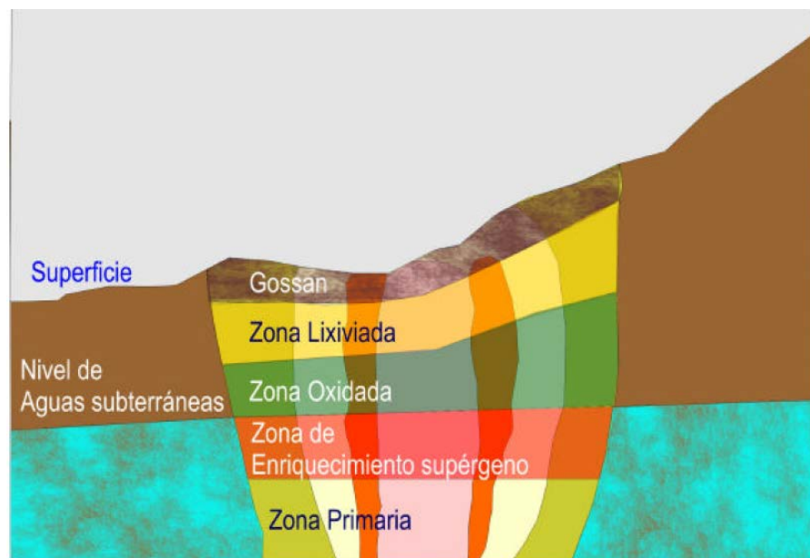
Figura 2.7: Zonación por efectos supérgenos en un pórfido cuprífero: Gossan o sombrero de hierro en la parte superior (óxidos e hidróxidos de hierro), seguido en profundidad por una zona lixiviada (escaso contenido metálico), luego de una zona oxidada (minerales oxidados de cobre; crisocola, atacamita, malaquita), luego una zona de enriquecimiento supérgeno (sulfuros secundarios; calcosina, covelina) y la zona primaria o hipógena en profundidad (sulfuros primarios;
