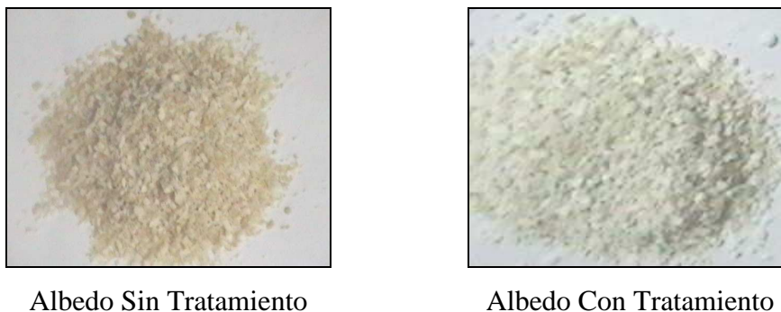
Figura 4.1.- Visualización del material sorbente al presentarse sin y con tratamiento previo.
