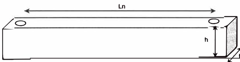
**Figura 1.1** Esquema dimensional de crucetas de madera
