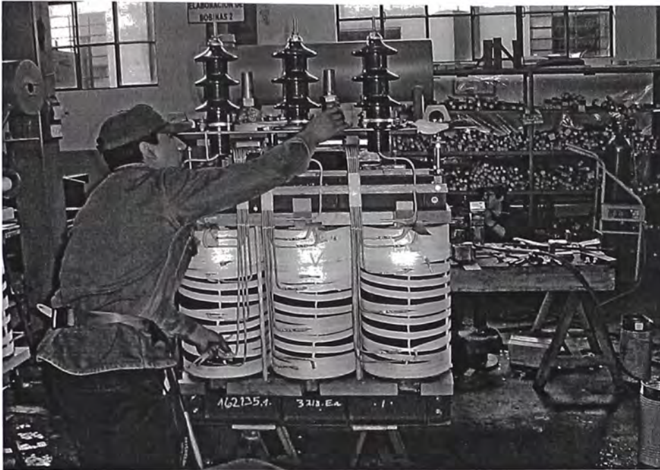
Fig. N° 4.5: Conexionado interno de un transformador (parte activa)
