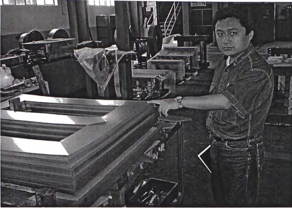
Fig. Nº 4.3: Proceso de apilamiento del núcleo de un transformador
