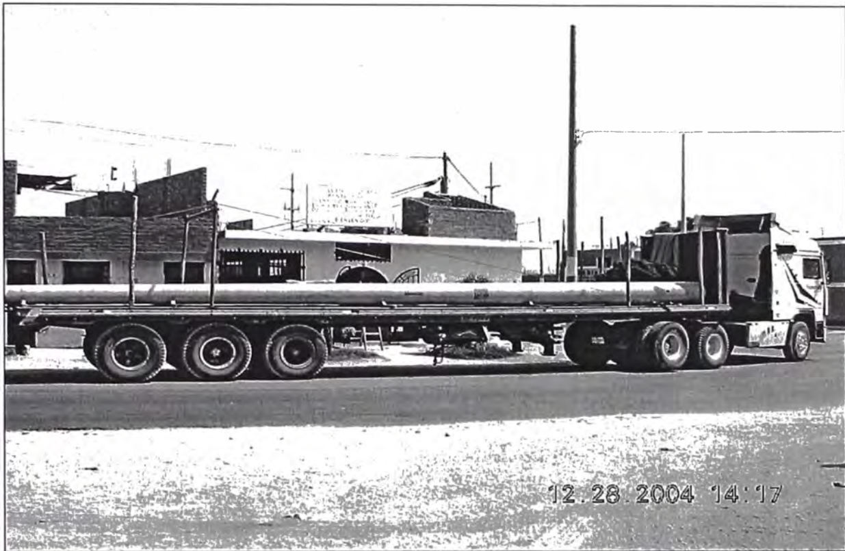
Fig. N° 4.33: Transporte de postes de 18m a obra 4
