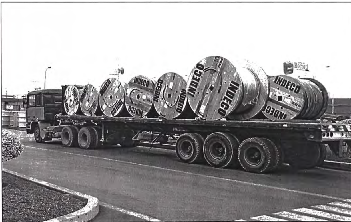
Fig. N° 4.24: Envío de conductores a obra 1
