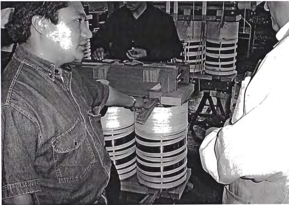
Fig. Nº 4.4: Ensamble de núcleo y bobina
