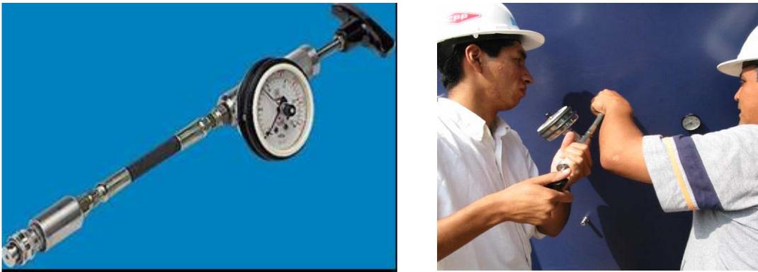
Fig. 21 Prueba de adherencia por tracción
