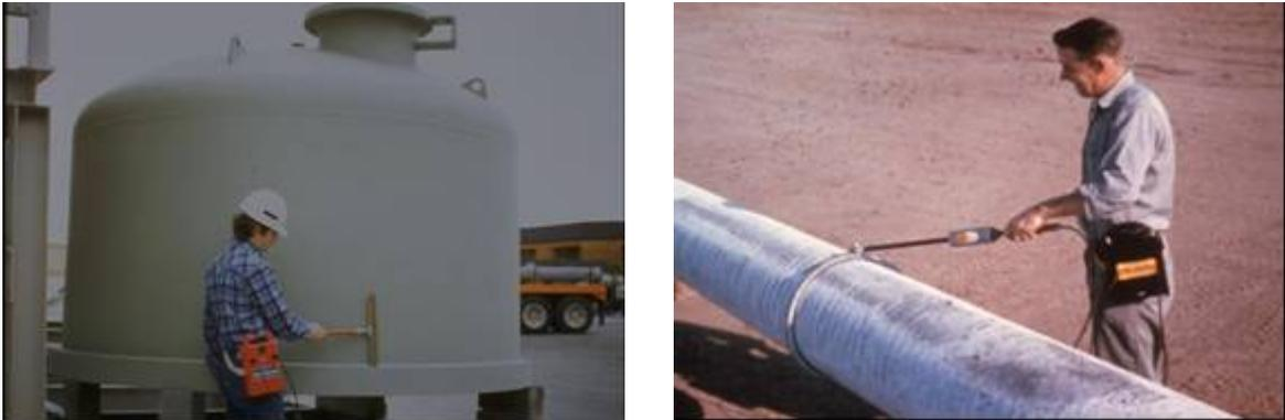
Fig. 19 Prueba de discontinuidad de alto voltaje
