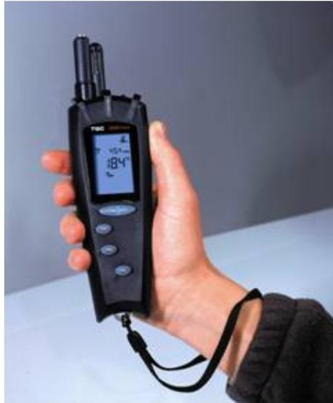
Fig. 2 Psicrómetro Digital
