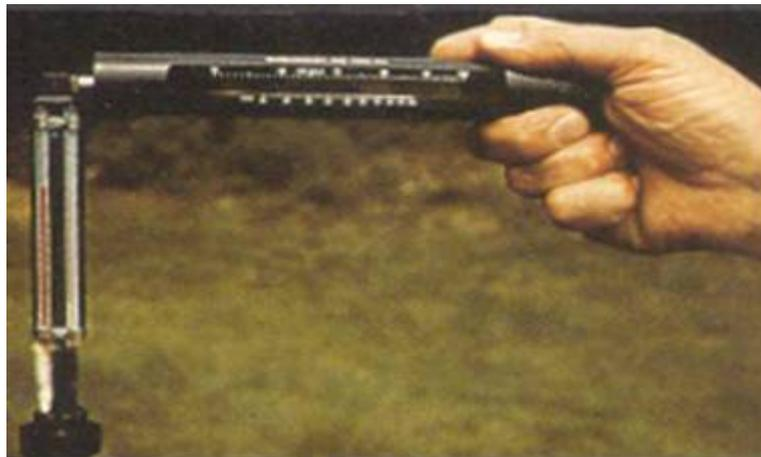
Fig. 1 Psicrómetro Giratorio Bacharach
