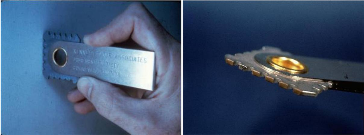
Fig. 14 Medidor de espesor de película húmeda
