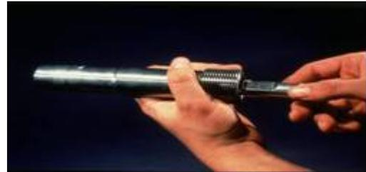
Fig. 7 Boquilla de "Arenado"
