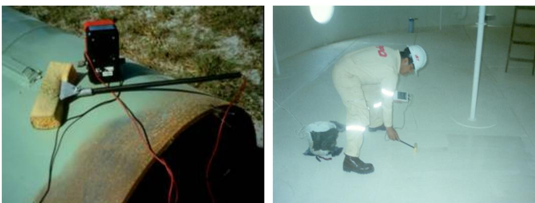
Fig. 18 Detector de discontinuidad de bajo voltaje
