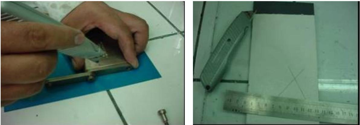
Fig. 20 Prueba de Adherencia por corte en cruz
