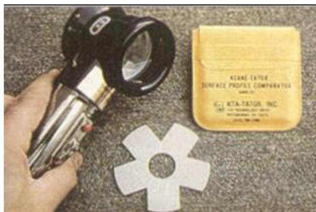
Fig. 13 Medición de la rugosidad
