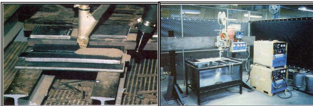
**Figura 3.10** Equipo de Arco Sumergido
