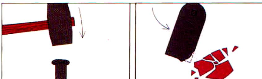
**Figura 4.4:** Comportamiento de la partícula abrasiva en desgaste por impacto
