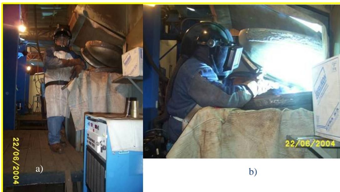
**Figura 6.15** a) Soldador con su equipo de protección personal, b) Se usa mantas térmicas para aislar el cangilón del contacto con acero al carbono.
