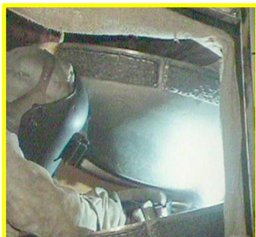
**Figura 6.16** Cangilón predeformado
