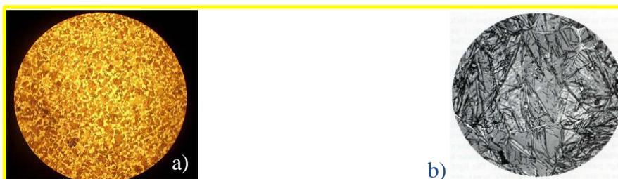
**Figura 2.4** a) y b) Identificación mediante metalografía de las fases presentes y de los tratamientos térmicos que ha sufrido el metal base.
