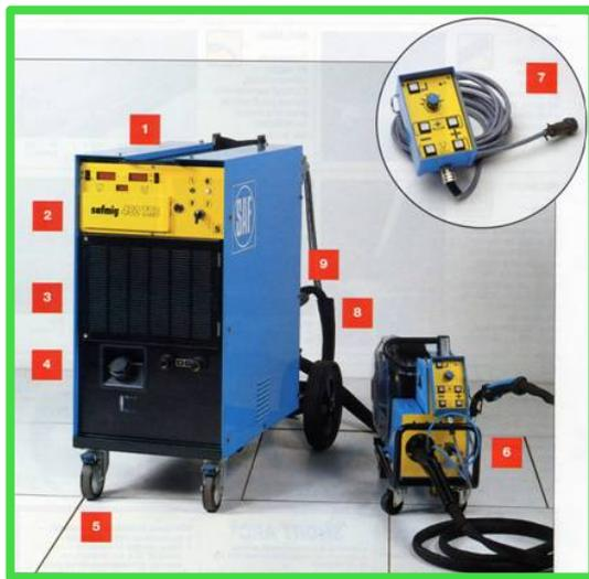
**Figura 6.13** Se aprecian la maquina GMAW, el alimentador, y la antorcha.
