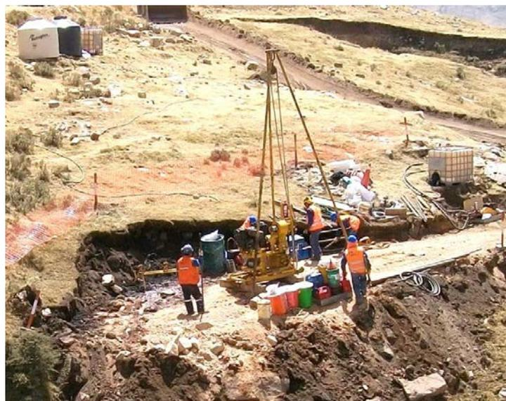
**Figura 3.7** Equipo de perforación diamantina rotativa.
