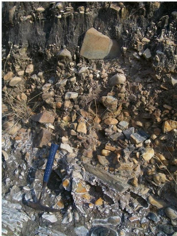
**Foto 4.** Material fluvioaluvial formado por fragmentos heterolíticos subredondeados con limos, arenas y arcillas.
