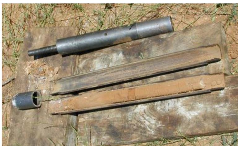
**Figura 3.9.** Tomamuestras de cuchara partida usado en el ensayo SPT.
