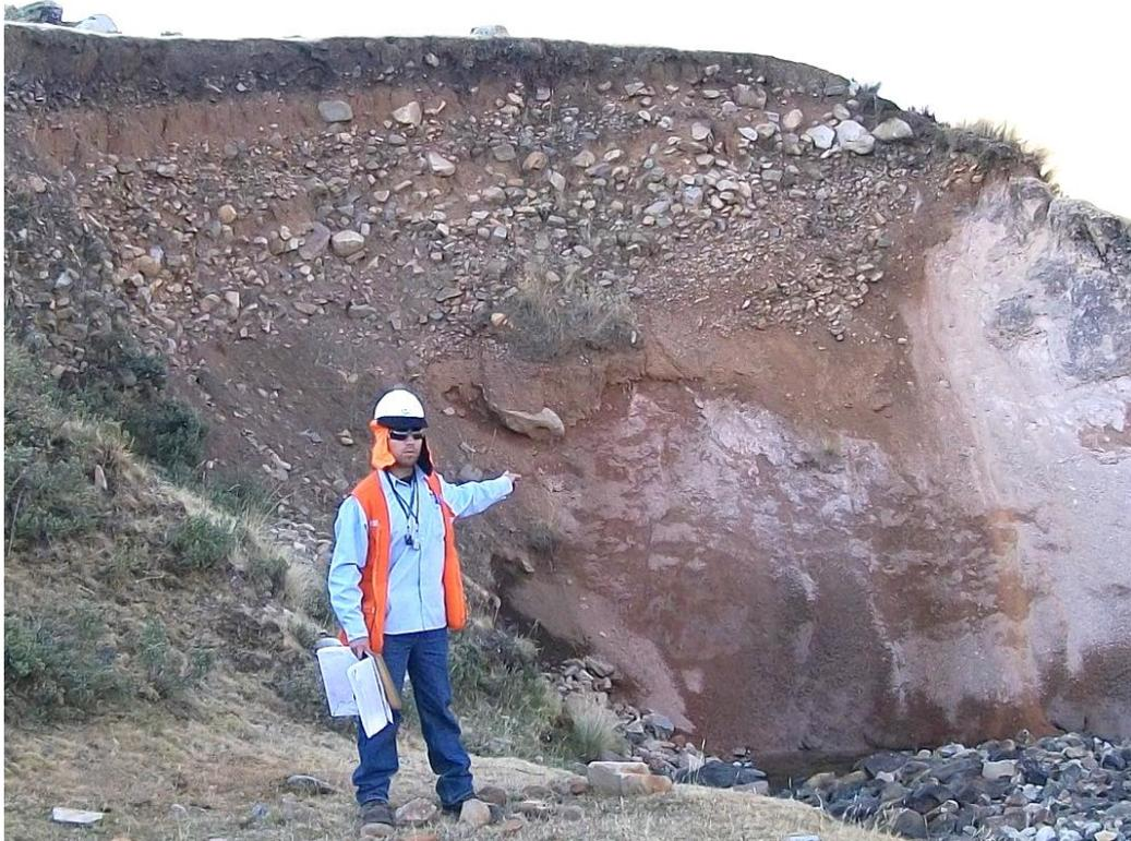
**Foto 2.3.** En esta imagen se observa una terraza colgada ubicada en la parte superior y hacia la parte baja material aluvial.
