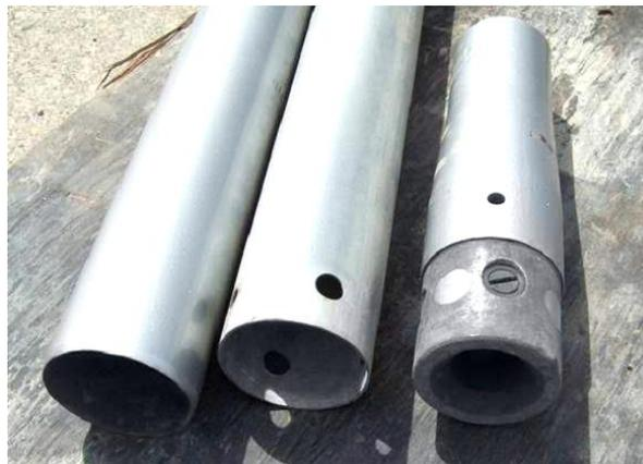
**Figura 3.14.** Tubos de pared delgada o tubos Shellby.
