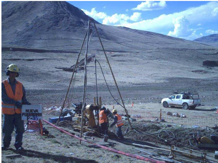
**Foto 6.** Equipo de perforación rotativa diamantina.
