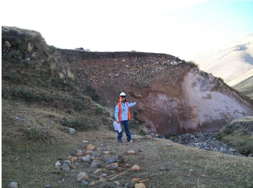
**Foto 5.** Vista de un perfil de suelo próximo a la zona de confluencia de las dos quebradas. La parte superior del corte corresponde a una terraza aluvial, el cual está formado por fragmentos subredondeados en matriz limo arcillosa.
