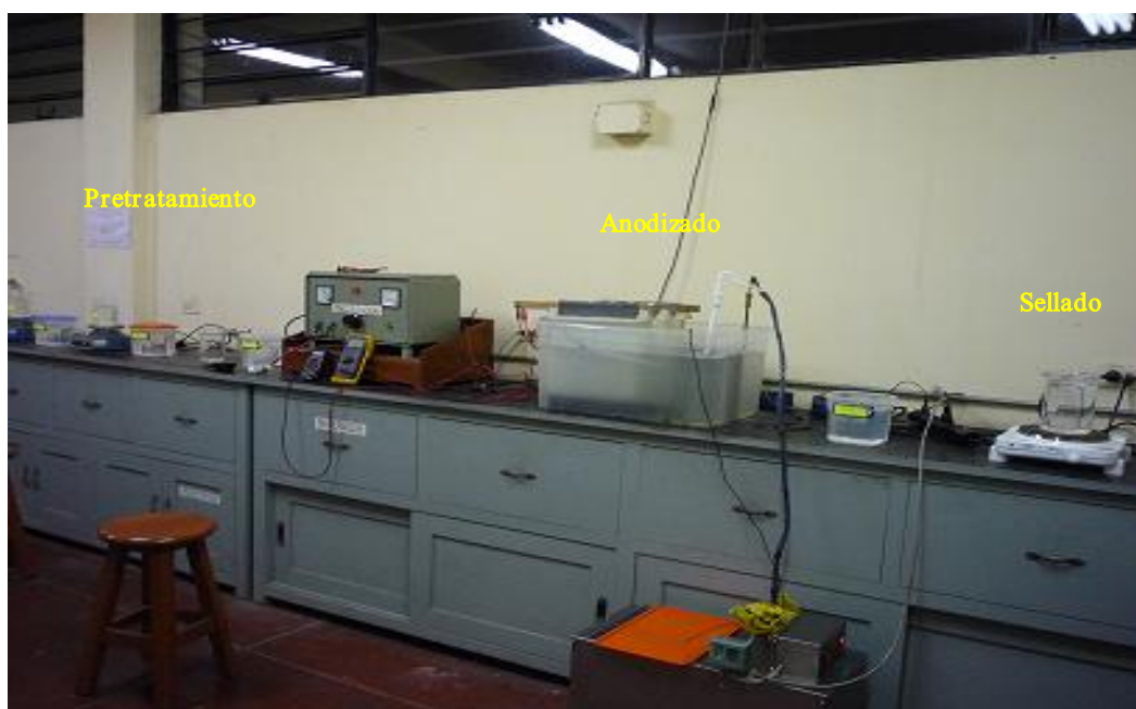
Figura 7.2.- Etapas en el proceso de anodizado
