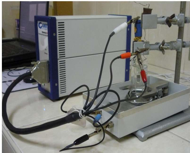
Figura 7.14.- Conexiones de la probeta con el equipo de GAMRY INSTRUMENTS
