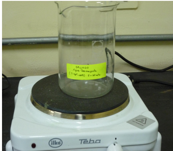
Figura 7.7.- Sellado del óxido de aluminio
