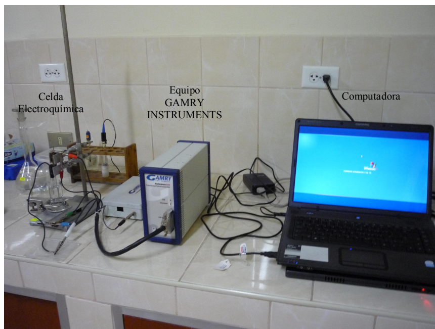
Figura 7.13.- Sistema de medición de la prueba de impedancia de la película de óxido de aluminio
