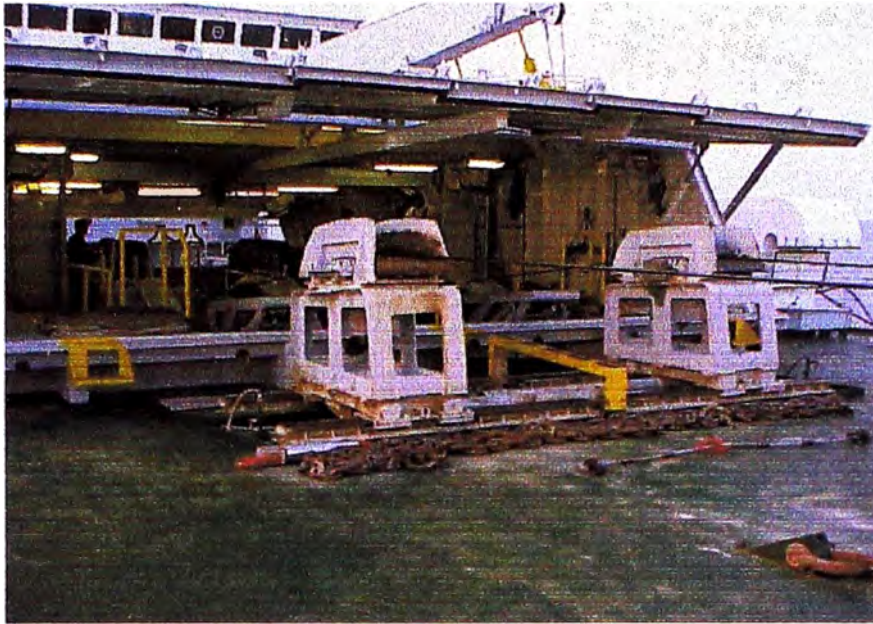
Fig. 2.31. Cable y empalme siendo jalados desde el interior del barco hacia la proa
