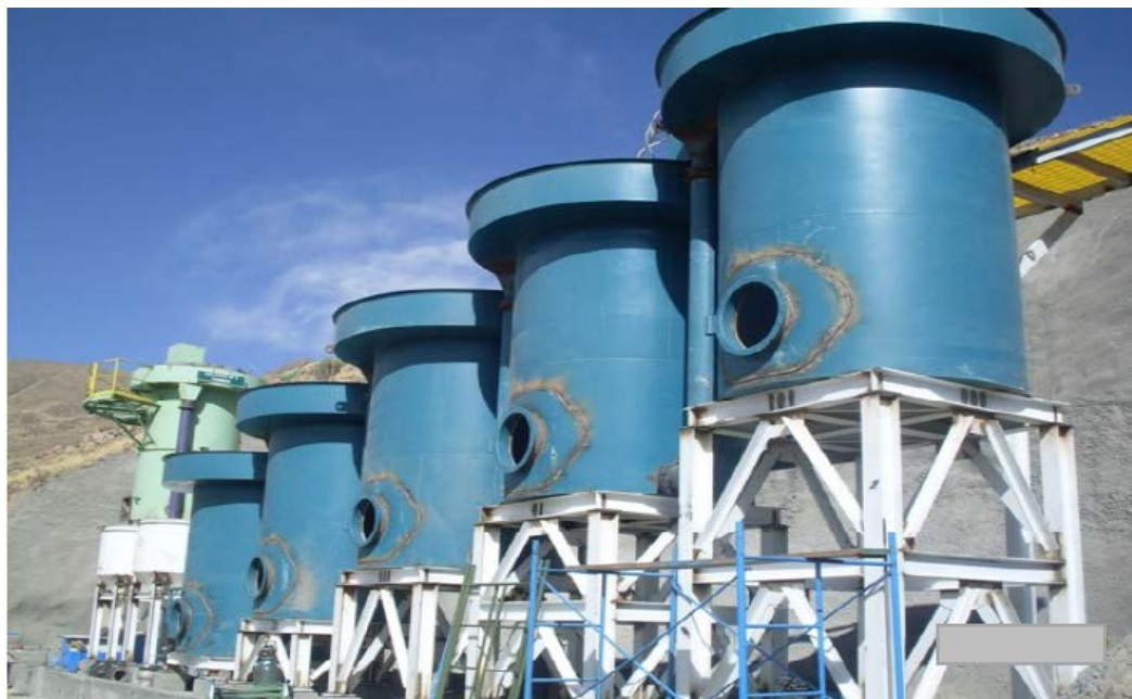
Figura. 6.2. Instalación de las Columnas de carbón para recuperación de Au y Ag de del agua de la Relavera
