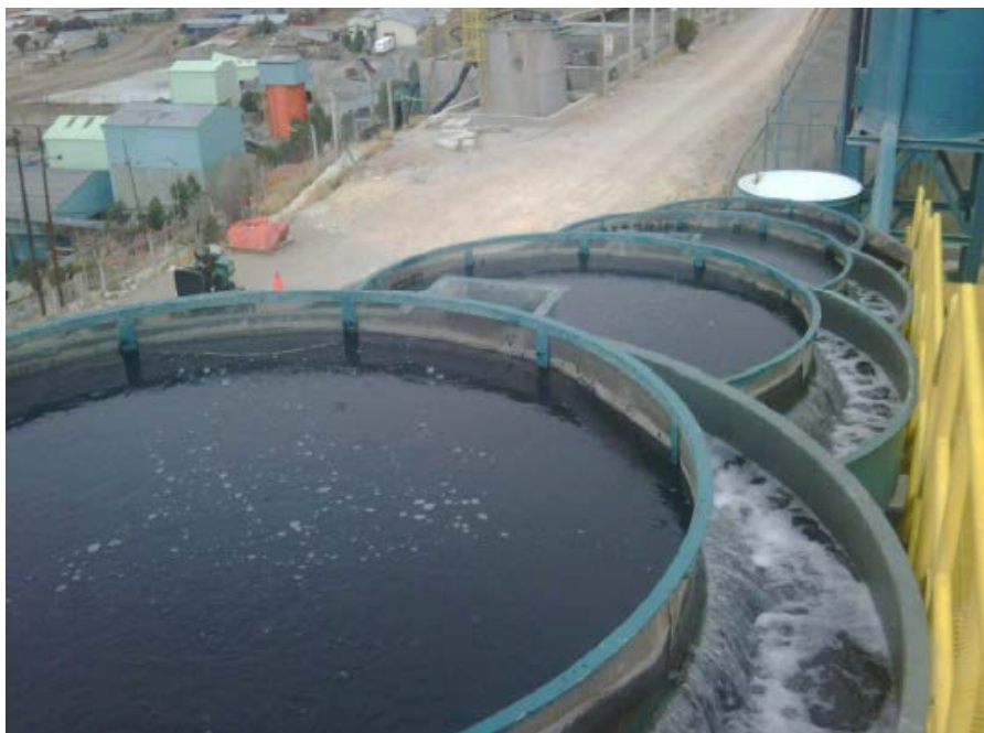
Figura. 6.4. Columnas de carbón en operación para recuperación de Au y Ag de del agua de la Relavera
