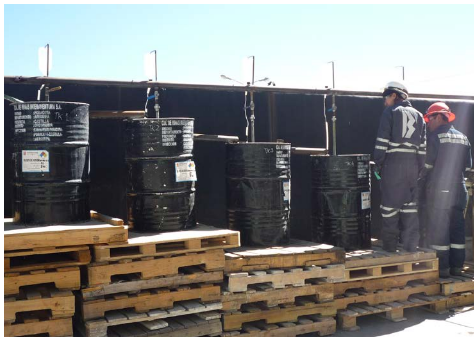
Figura N° 3.2.- Planta piloto para pruebas de destrucción de cianuro mediante la oxidación avanzada
