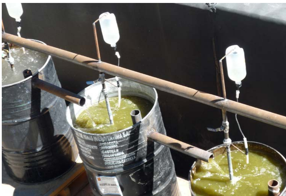
Figura N° 3.2.- Planta piloto para pruebas de destrucción de cianuro mediante la oxidación avanzada
