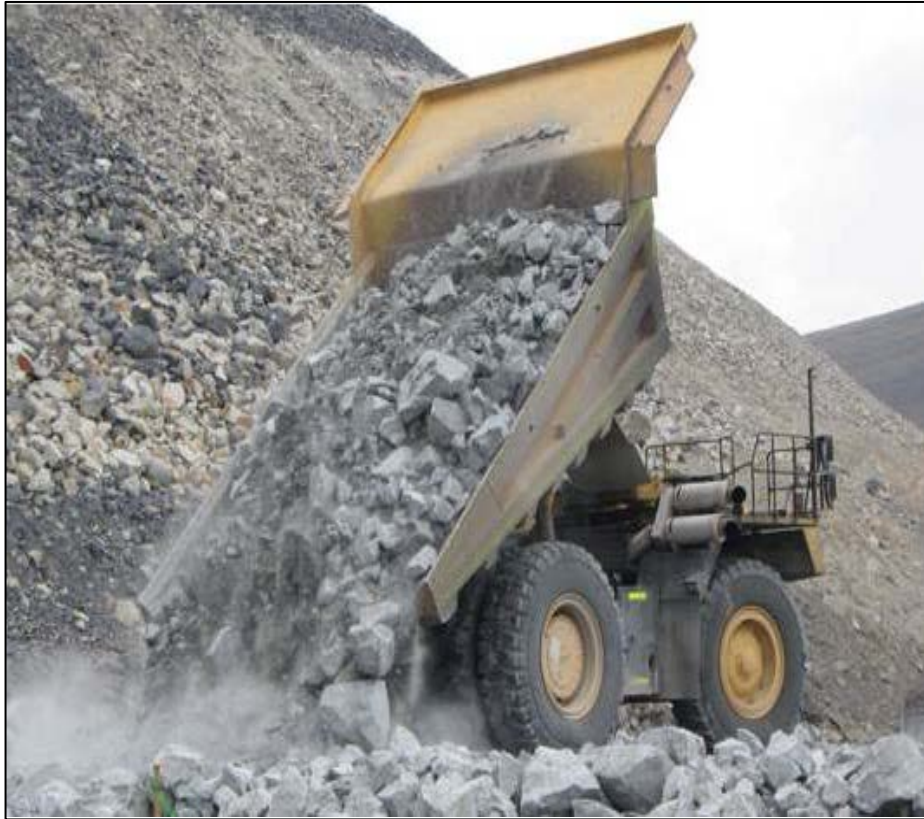
Figura 1.16 Descarga de material trasladado de la cantera [21]
