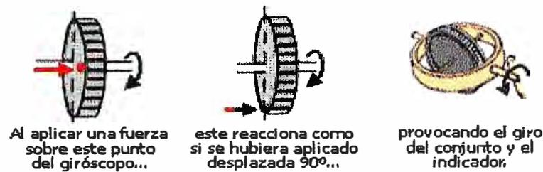
**Figura 1.14:** Principio de funcionamiento del Indicador de Viraje
