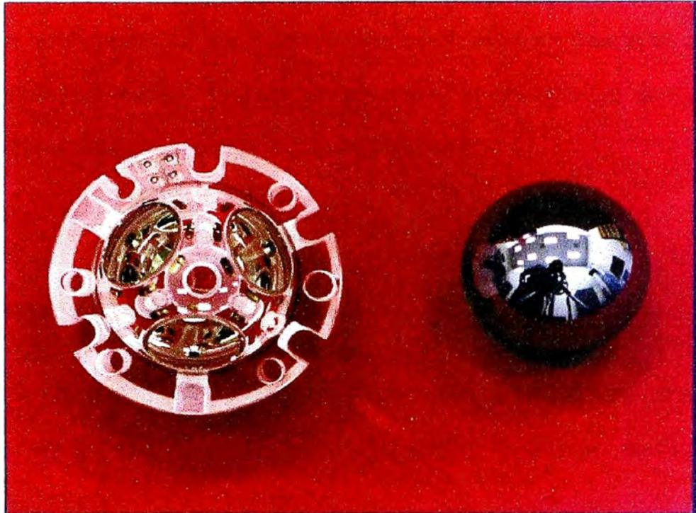
**Figura 1.3:** Vista del encapsulado que contiene al rotor y al rotor mismo
