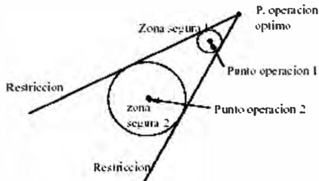
**Fig..2.10. Punto de operación óptimo de un proceso típico**
