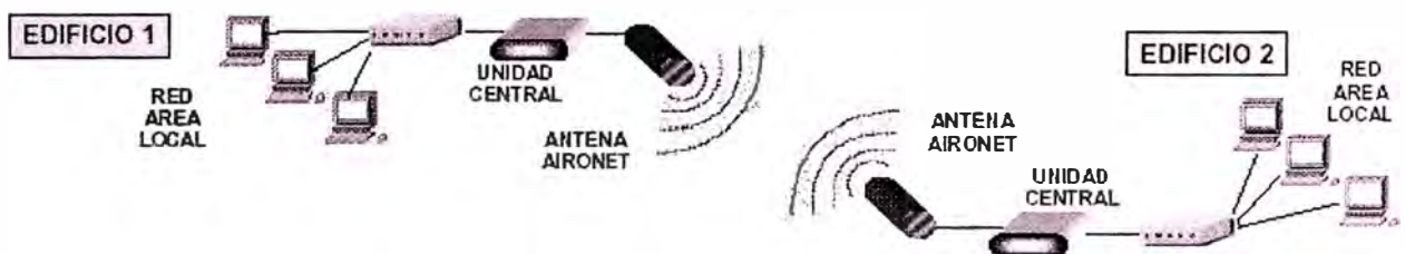
Figura 2.3: Conexión de 2 edificios (Redes LAN)
