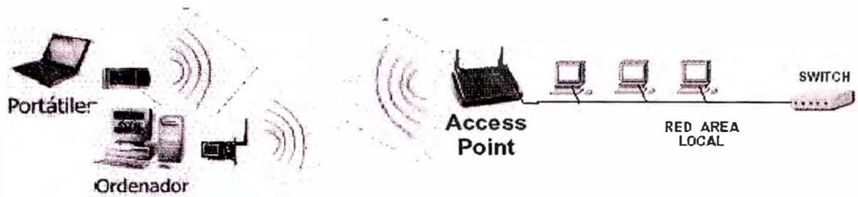
Figura2.2: Acceso inalámbrico de una PC portátil
