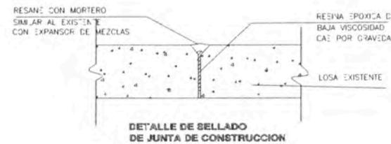
**DETALLE DE SELLADO DE JUNTA DE CONSTRUCCION**
