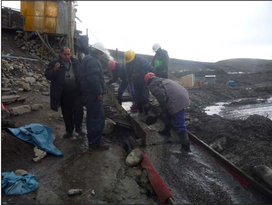
Figura N°6.9 Se observa el proceso de recolección del concentrado de oro con la amalgama.
