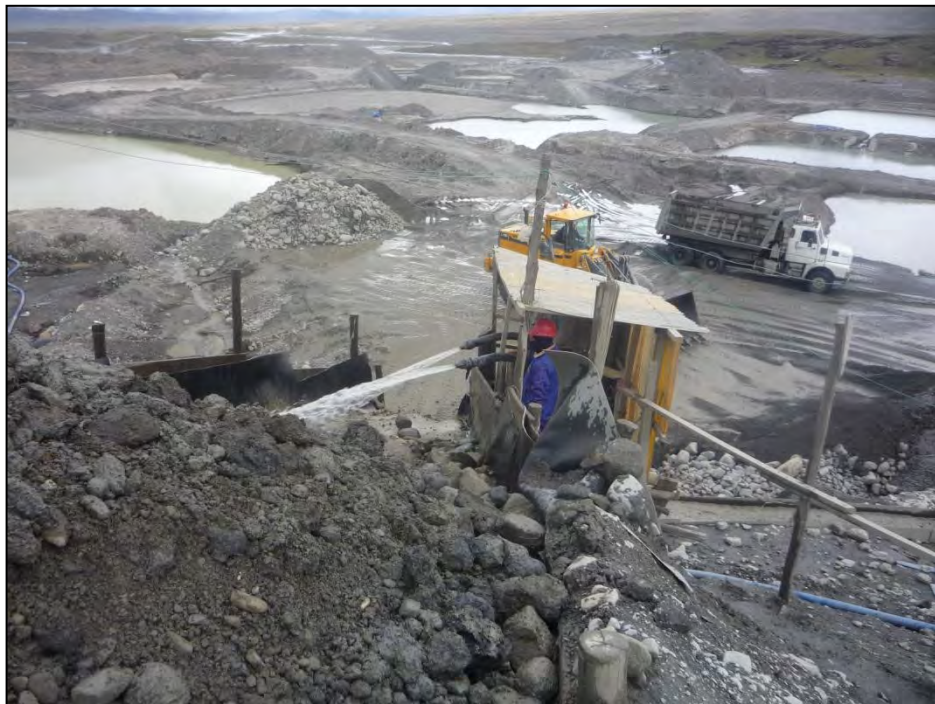
Figura N°6.8 Obsérvese el tratamiento del mineral, las canaletas que contiene las arenas negras con oro y al fondo en el lado izquierdo, la zona de Pozas de Lodo.
