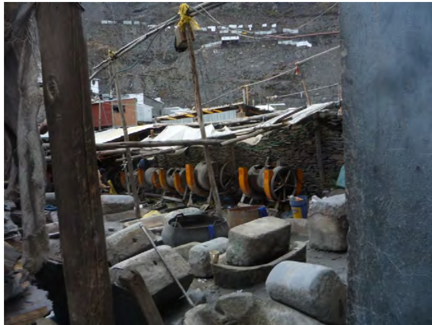
Figura N°3.3 Se observa 5 tambores y varios quimbaletes ubicados dentro de las viviendas en la naciente de la cuenca alta del río Ramis zona minera Cerro Lunar
