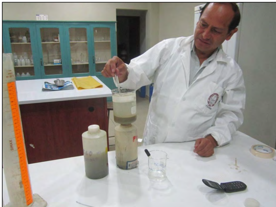
Figura N°6.18 Muestra dosificando el floculante MAGNAFLOG para incrementar las velocidad de sedimentación en los laboratorios del IMMA-UNI.
