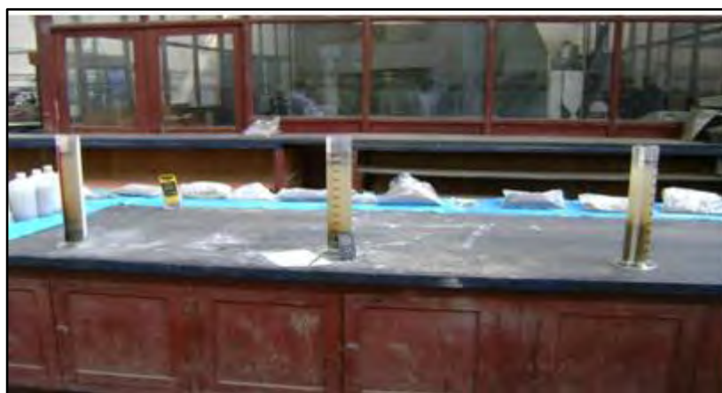
Figura N°6.16 Muestras de agua en frascos y sedimentos en bolsas tomada en la Poza N° 1 del Desarenador y preparando la muestra para las pruebas de sedimentación en los laboratorios del IMMA-UNI y Laboratorio N°9 de la FIGMM.
