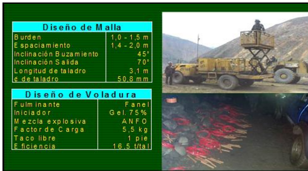
Imagen 3.3: Fotografía de Equipo de carguío para la Voladura
