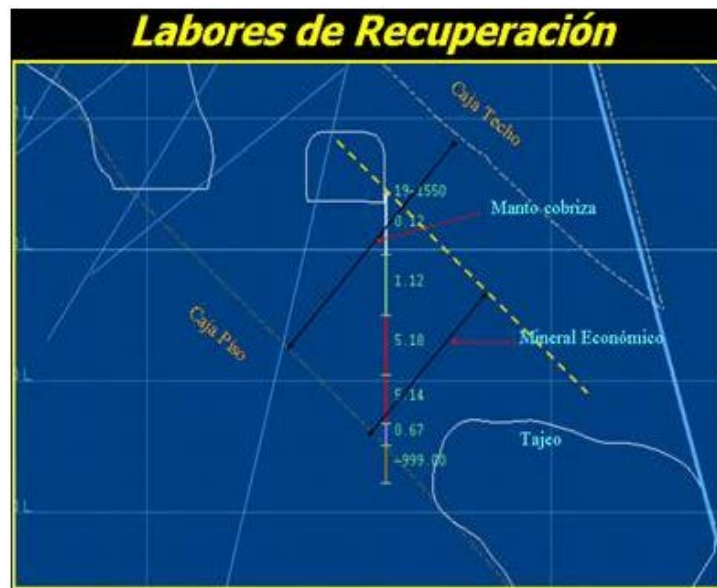
Imagen 4.2: Vista de sección.
