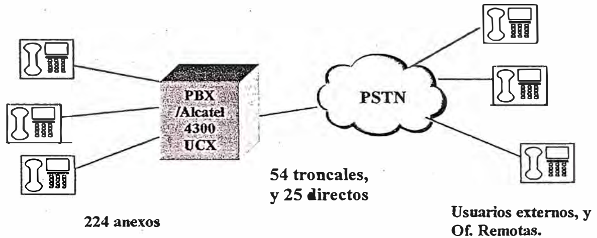
Fig. 1.1 Esquema actual de red de Voz en la empresa
