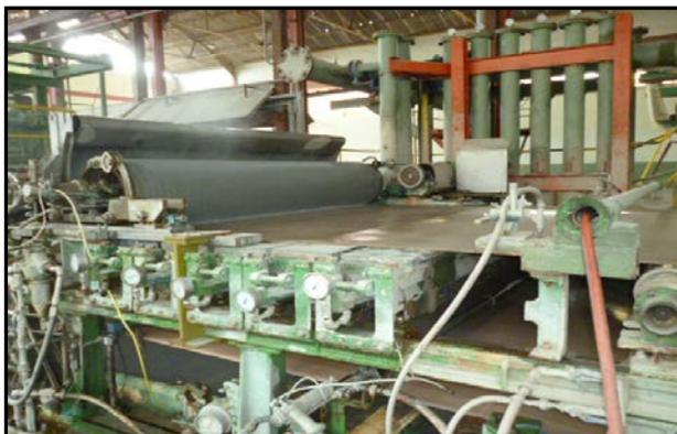
**Fig.31.** Cajones cuyo rango de vacío se mide en "Hg.
