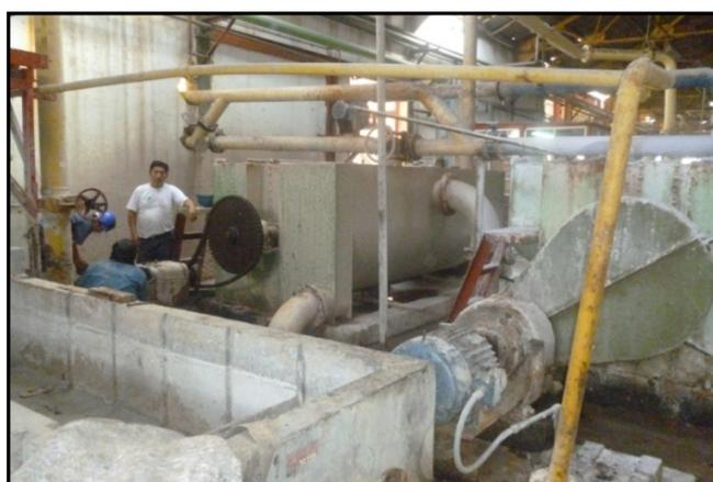
**Fig 14.** Deckers o espesadores de pulpa.
