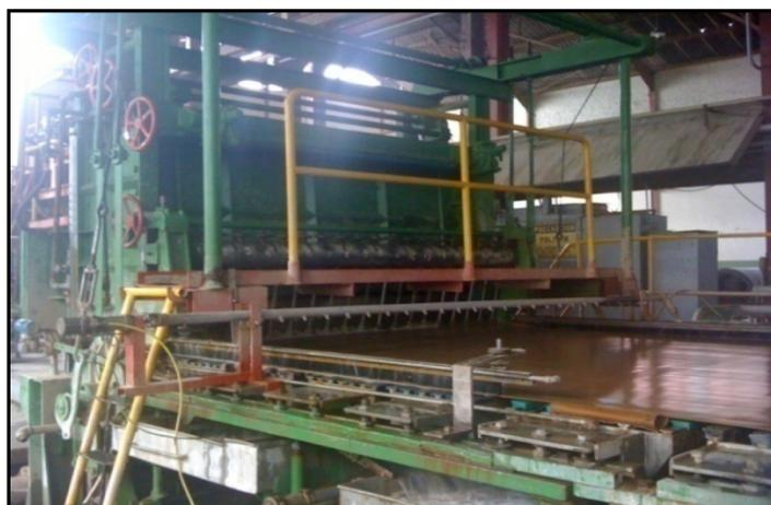
**Fig.17.** Caja de entrada abierta mesa plana PPX 1.
