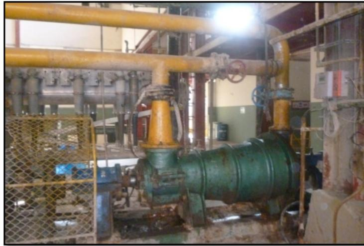
**Fig.15.**Refinador de pasta para la formación de fibrilas.
