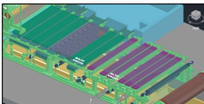
**Fig 58.** Modelado 3d de los cajones de bajo y alto vacío.
