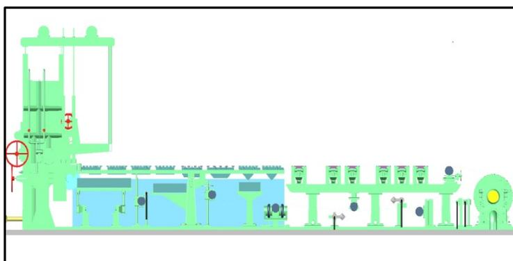
**Fig.2.** Disposición de elementos de drenaje en la mesa plana.
