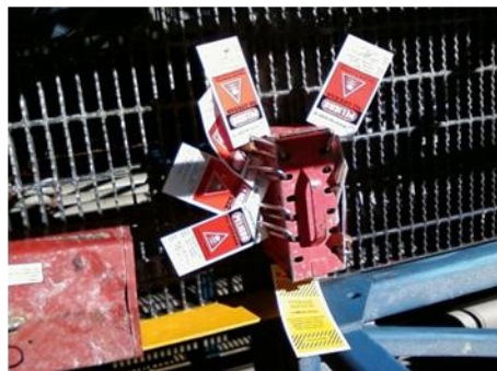
Fig. 2.1: Aislamiento de Energía
