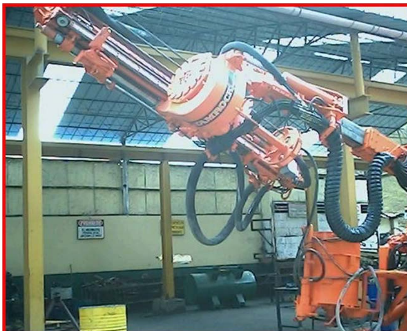
FIGURA 28: EQUIPO TAMROCK – ROBOLT (RULETA PARA 10 PERNOS)
