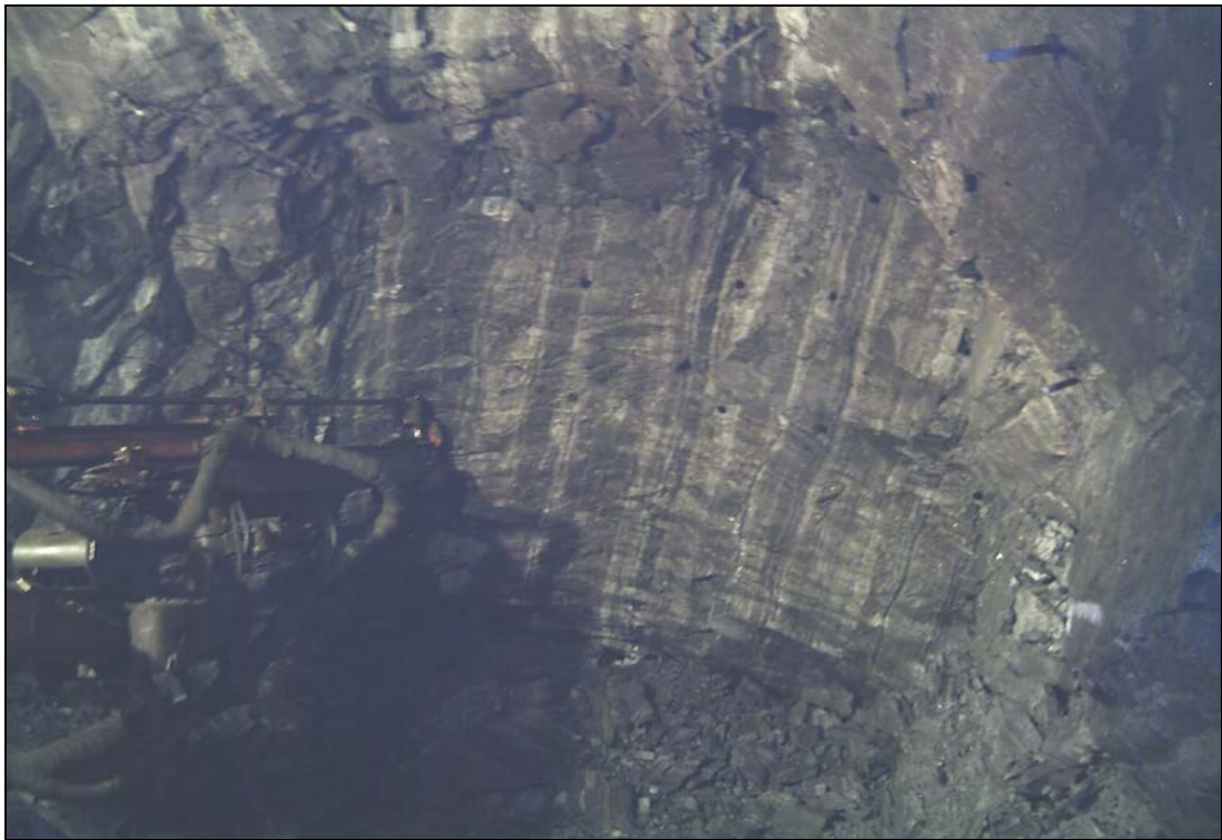
FIGURA 23: PERFORACIÓN EN BREASTING
