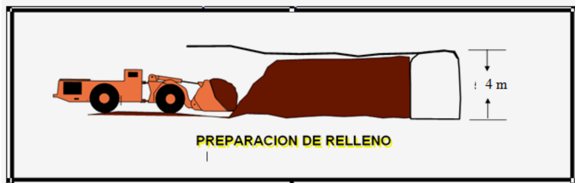
FIGURA 18: PREPARACIÓN DE RELLENO
