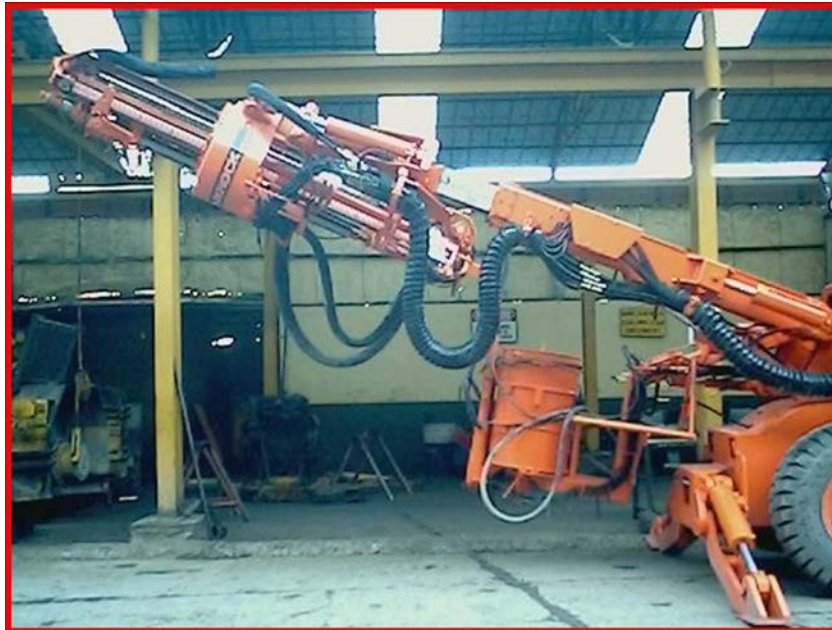
FIGURA 27: EQUIPO TAMROCK – ROBOLT (INYECTOR DE LECHADA DE CEMENTO)
