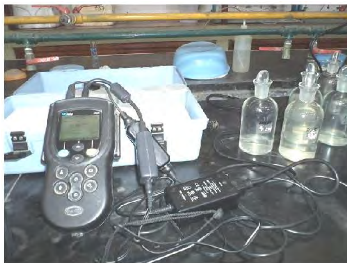
Figura 5-15: Medidor de oxígeno disuelto y frascos de ensayo de DBO 5
