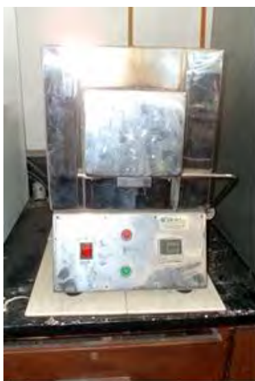
Figura 5.20: Mufla de calcinación para la determinación de sólidos volátiles
