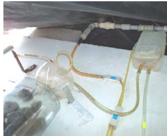
4. Zona de mezcla del efluente del reactor UASB con el caudal recirculado del DHS y zona de ingreso al sistema DHS
