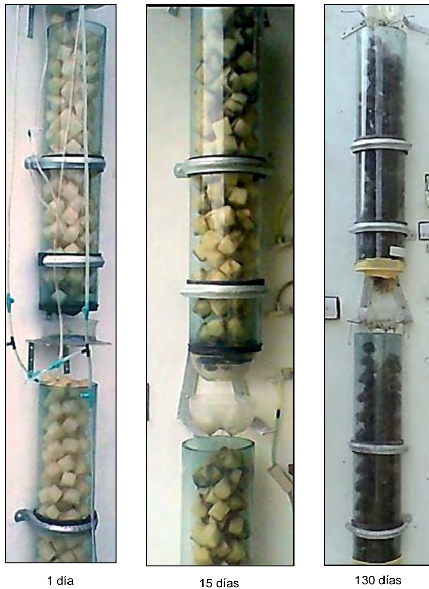
Figura 2.12: Evolución de la película biológica en el sistema DHS
