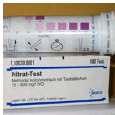
Figura 5.17: Tiras indicadoras Merckoquant para la medición de Nitritos y Nitratos
