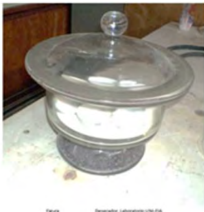
Figura 5.19: Desecador de crisoles de porcelana
