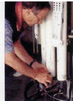
Un científico extrae una muestra de agua de una botella Niskin montada en un dispositivo múltiple de muestreo de agua. El cilindro blanco es la botella Niskin. El marco plástico blanco unido a la botella Niskin puede contener hasta tres termómetros reversibles, y rota alrededor de su centro cuando la botella Niskin se cierra. (Foto © 2000 CSIRO Marine Research, permiso de reproducción.) La [figura 13.13](#) da otra vista de las botellas Niskin en una roseta.
