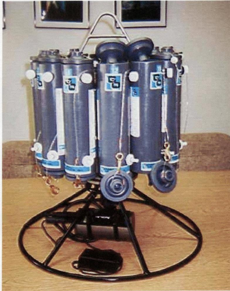
Dos ejemplos de un dispositivo múltiple de muestreo de agua con botellas Niskin. El dispositivo en la primera figura es un diseño para aguas someras y aplicaciones estuarinas; lleva 12 botellas Niskin de volumen relativamente pequeño. Se muestran dos botellas en posición abierta, cuando el agua puede pasar a través de ellas. Las botellas restantes se muestran en posición cerrada.
