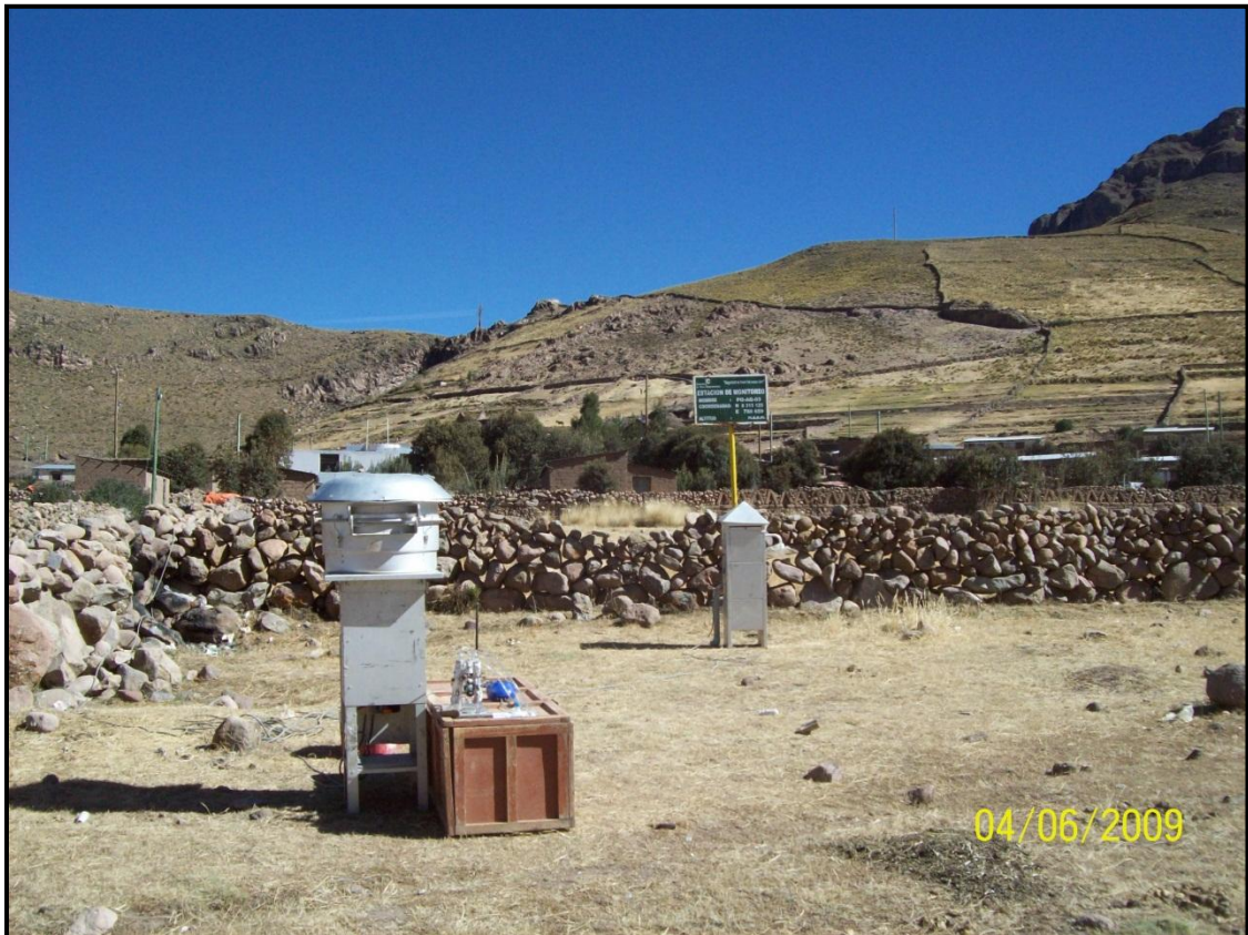
Figura 3.3 Equipos de muestreo Hi Vol PM10 (izquierda) y PTS (derecha)
