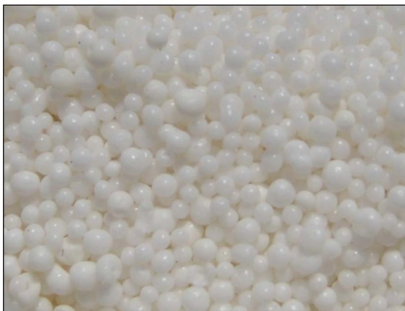
***Figura N° 25. Vista donde se observa los prill blanco de Nitrato de Amonio Técnico de la empresa rusa JSC "AZOT" Berezniki.***
