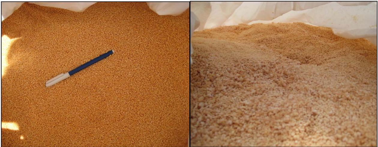
**Figura N° 08.** Al lado izquierdo se observa los prill color naranja y al lado derecho el efecto causado por la temperatura cuando se sobrepasa los 32,1 °C.
