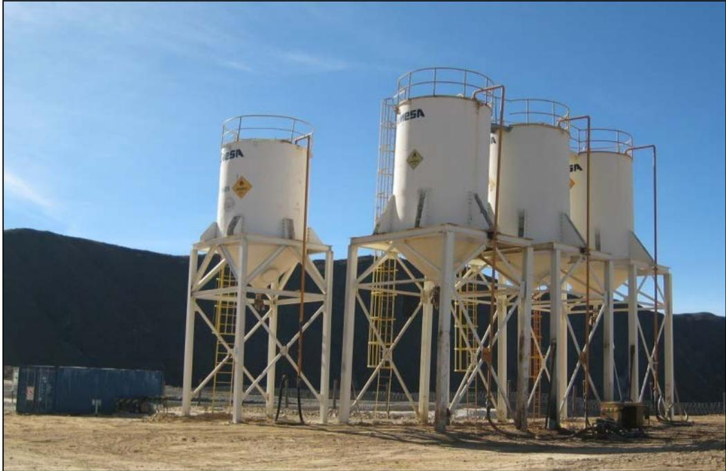
**Figura N° 19. Silos o depósitos de almacenamiento de Emulsión Matriz instalados en la mina.**
