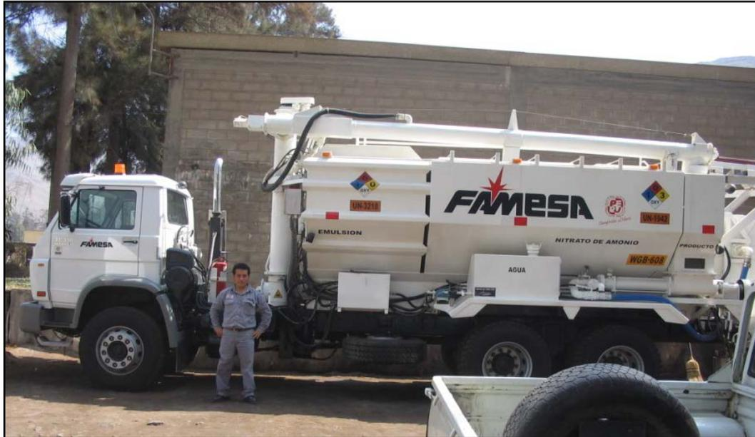
**Figura N° 17. Camión fábrica de la empresa Famesa Explosivos S.A.C. para el mezclado de Emulsión Matriz, Nitrato de Amonio y Petr leo.**
