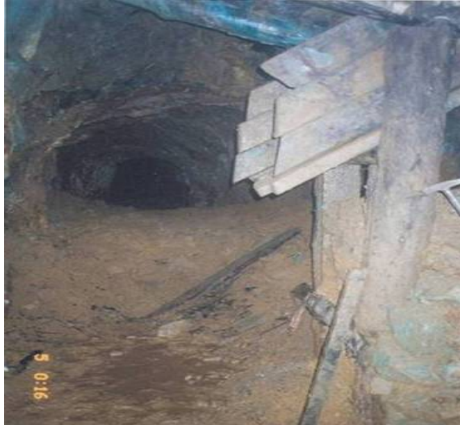
FIGURA 12: GALERÍA CON TOLVA DE EXTRACCIÓN EN MINA CHINCHINGA
