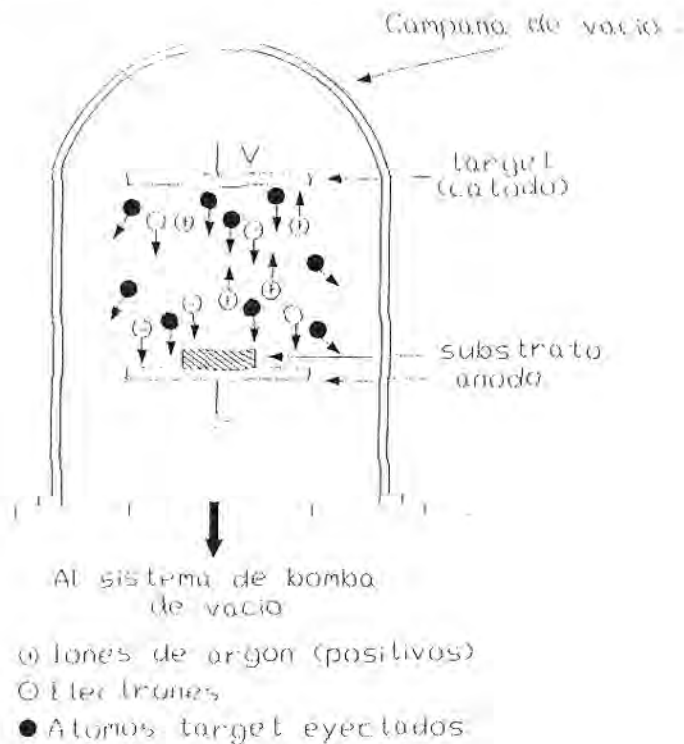
Fig. II.3. Esquema de un proceso de Sputtering
