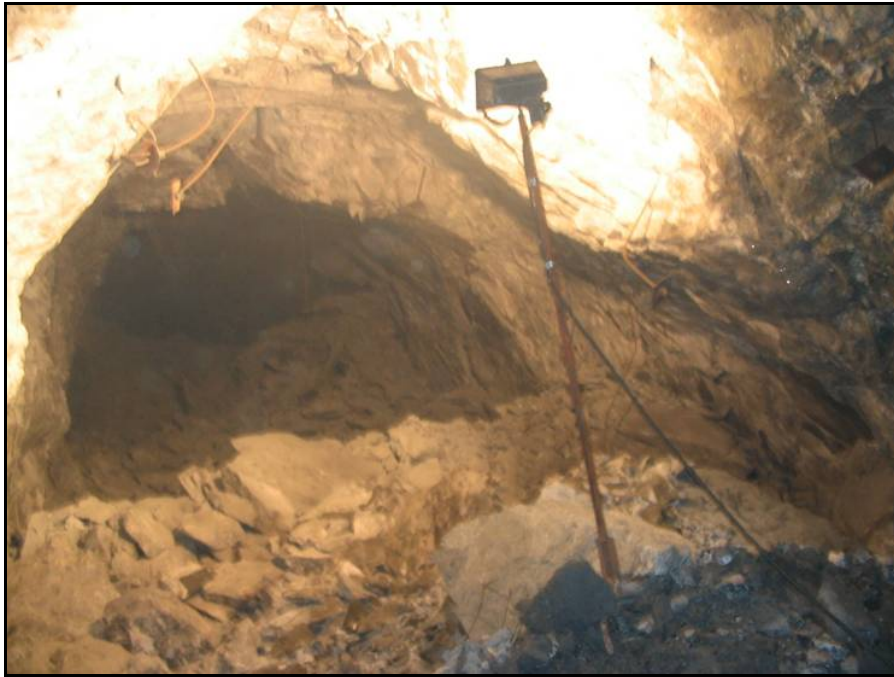
Figura 22 Estallido de rocas durante la labor de sostenimiento convencional en el tajo -880 V3N
