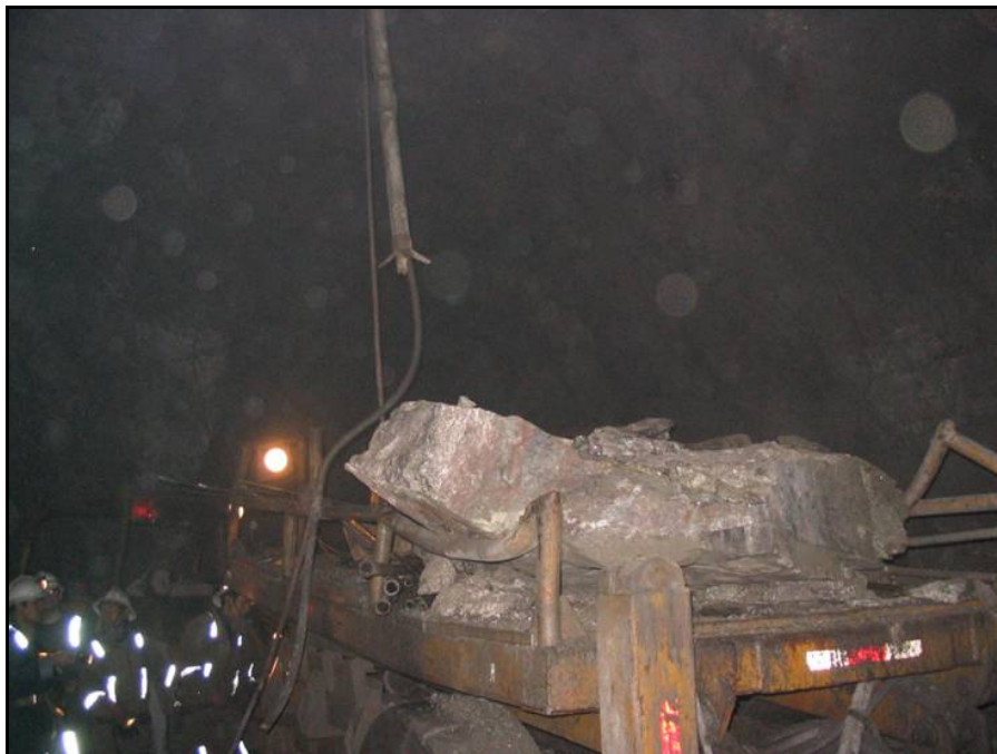
Figura 22 Estallido de rocas durante la labor de sostenimiento convencional en el tajo -880 V3N
