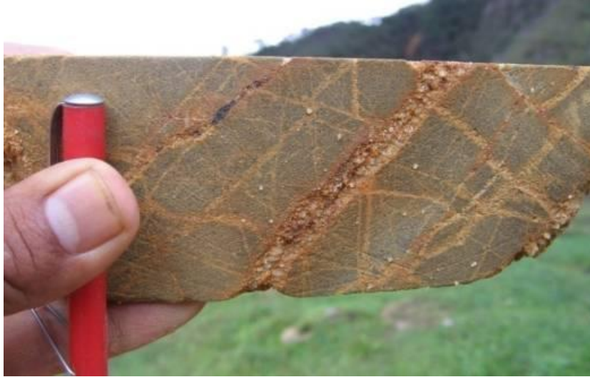
Foto N° 11: VC Andesita Volcánica Porfirítica con alteración argílica con sobreimpresión de argílico, venas de cuarzo con smectita é illita. Cu 0.68%.
