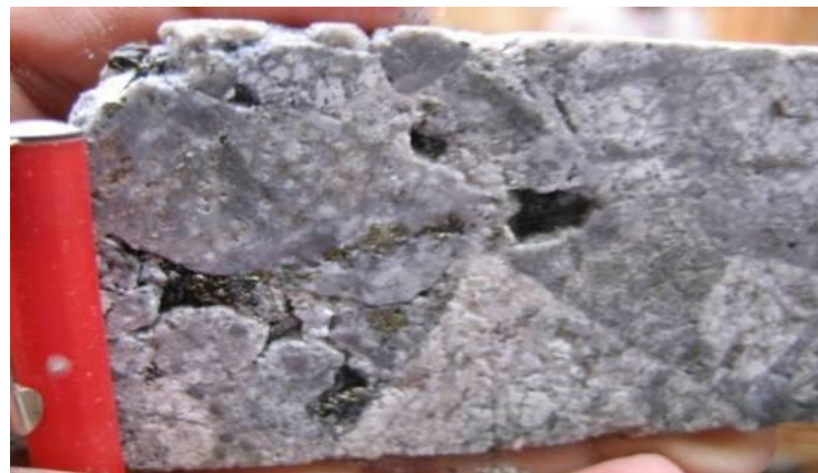
Foto N° 16: IBxP Brecha Polimíctica, brecha / silicificación con pirita masiva diseminada, calcocina y calcopirita.
