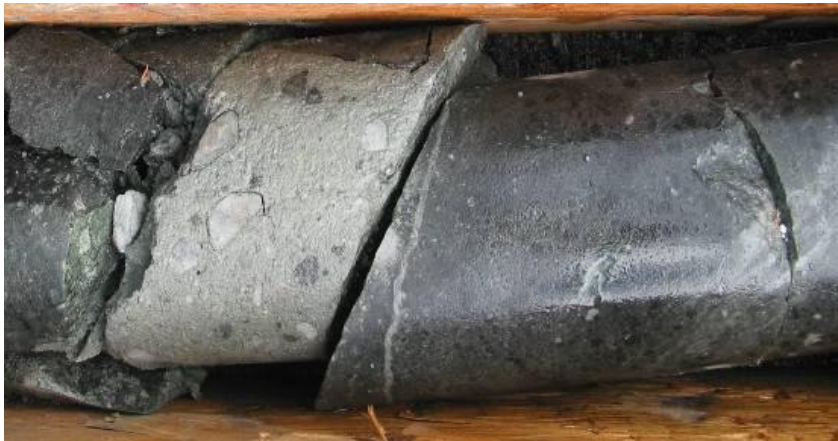
Foto N° 10: FP Pórfido feldespato diques, masa de grano fino y fenocristales de feldspatos y hornblenda.
