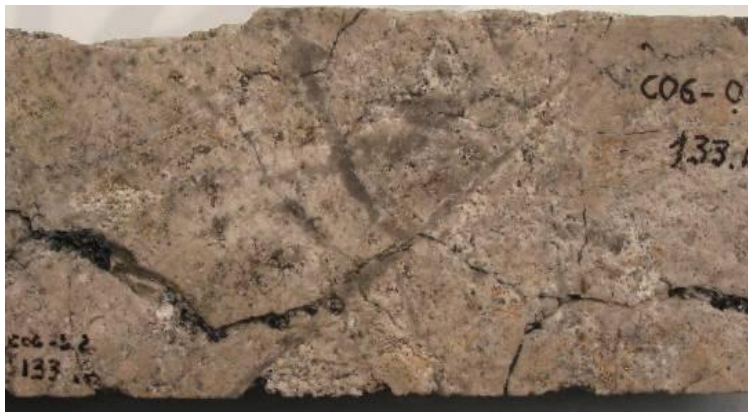
FotoN°27: Alteración Argílica avanzado. pirofilita - alunita - caolinita - illita.
