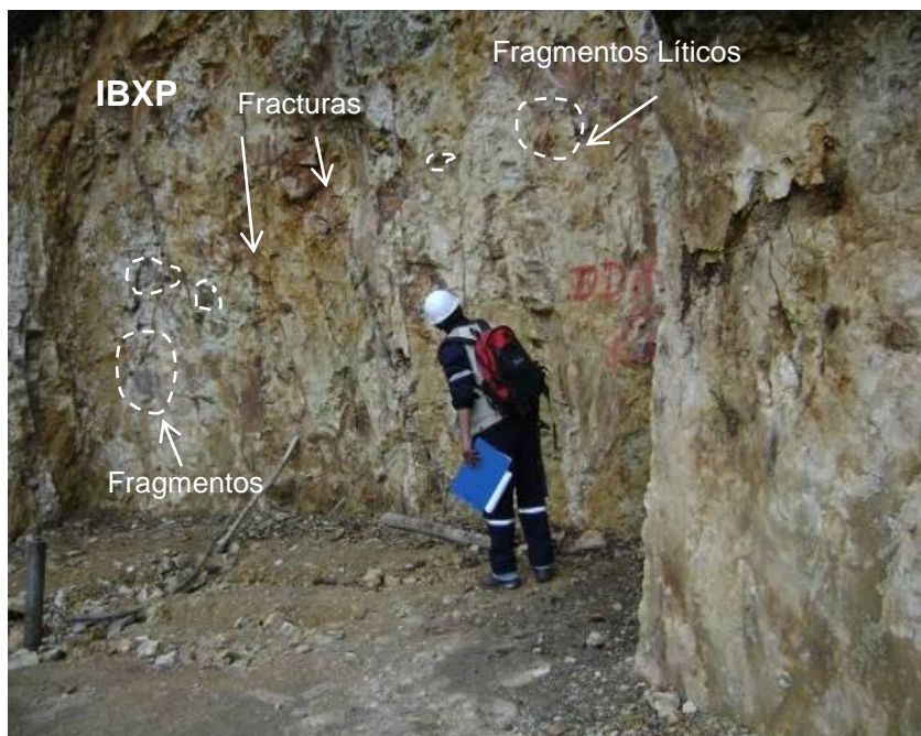
Foto N° 13: En la foto, se muestra una plataforma de perforación, en roca brecha ígnea polimíctica, (IBXP) nótese fragmentos líticos de tamaños variados 2cm a 40cm de BFP, CQP de fragmentos de roca sub-redondeados, fracturas subverticales, zona de mayor interés por el alto contenido de leyes de cobre, zona central.
