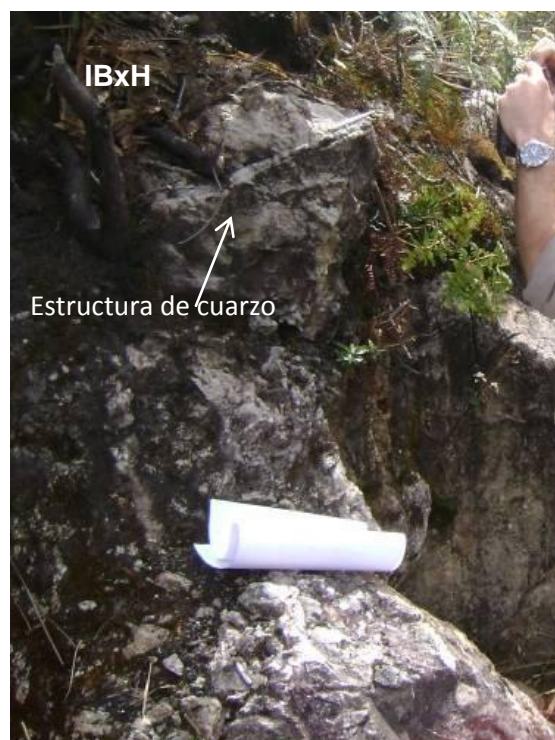
Foto N° 14: En la foto, se muestra una brecha ígnea hidrotermal, con una estructura de cuarzo.
