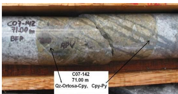
FotoN°19 Vetilla tipo B, venilla de qz-ortosa-cpy en clasto de VC, cortada por otra evento posterior de cpy-py-ch, a la venilla y a clastos de VC y BFP (IBXP).
