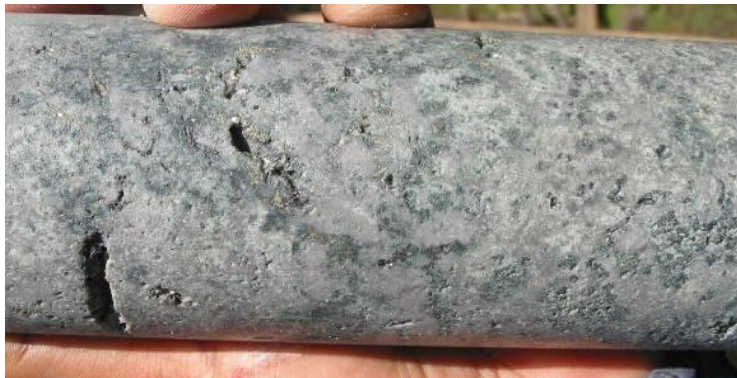
FotoN°26 Alteración Argílica Intermedio, clorita-esmectita-sericita.
