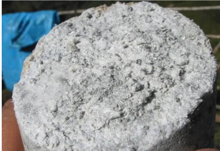
FotoN°23: Alteración Fílica con Calcocita diseminada con 0.52% Cu, ensamble qtz-sericita-pirita +/- ka, en CQFP.
