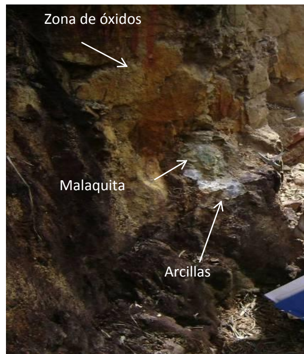
Foto N° 29: En la foto, se muestra una zona de óxidos, arcillas muy lixiviada, presencia de malaquita, y arcillas.
