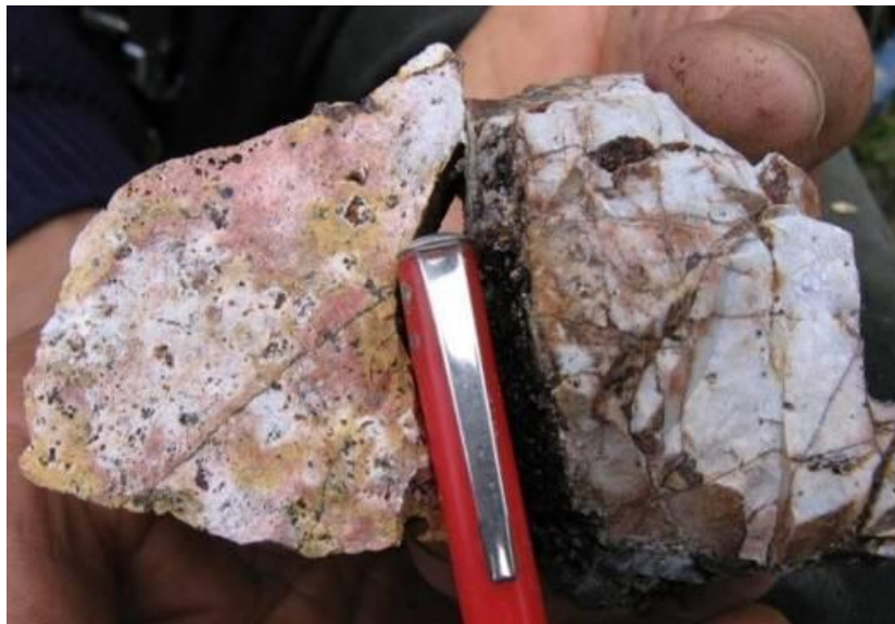
Foto N° 12: VC Tufo Dacítico de grano fino con alteración Fílica, venas de cuarzo stock work con calcocita.
