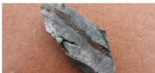
FotoN°21 Vetilla tipo M, venilla de mt,cpy,py, de espesor menor a 0.5cm, en clasto de CQP, con alteración propilítica.
