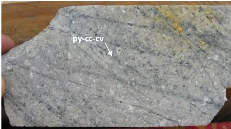
Foto N° 9: CQFP pórfido Cuarzo Feldespato. Con alteración cuarzo sericita con stockworks de cuarzo, contiene py-cc-cv.
