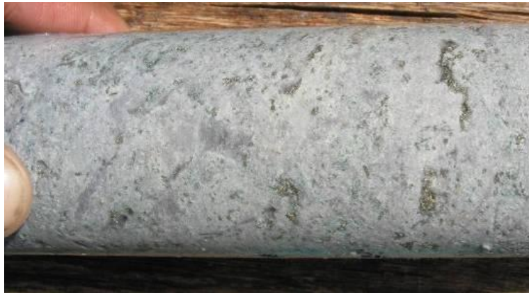
FotoN°25: Alteración Argílica. El ensamble caolinita-illita.
