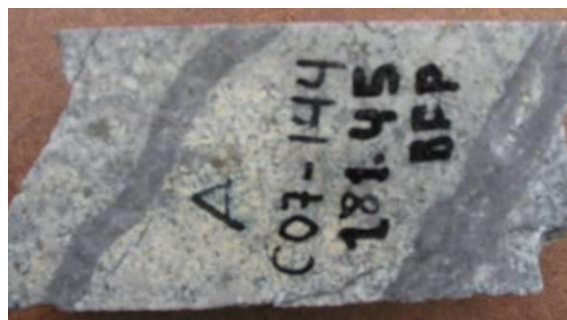
FotoN°18 Vetilla tipo A, venilla sigmoidal qtz-py-cpy-bo en CQFP con alteración fílica.
