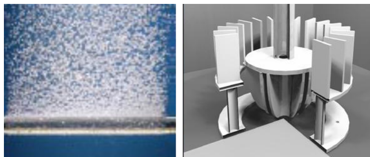
Figura N° 2.1: Generadores de burbujas – material poroso y sistema de impulsor
