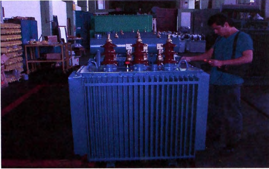
Fig. 3.6 Encubado del transformador
