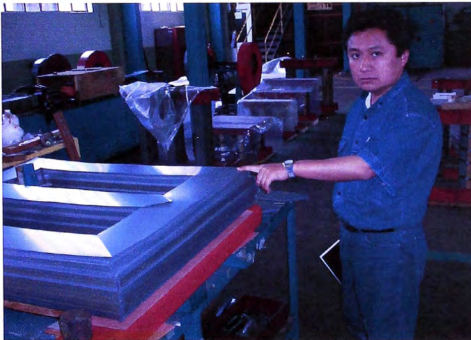
Fig. 3.3 Proceso de apilamiento del núcleo de un transformador
