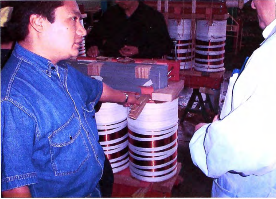
Fig. 3.4 Ensamble de núcleo y bobina
