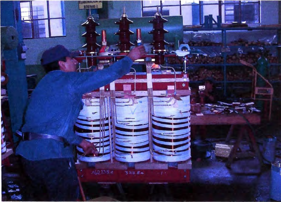
Fig. 3.5 Conexionado interno de un transformador (parte activa)
