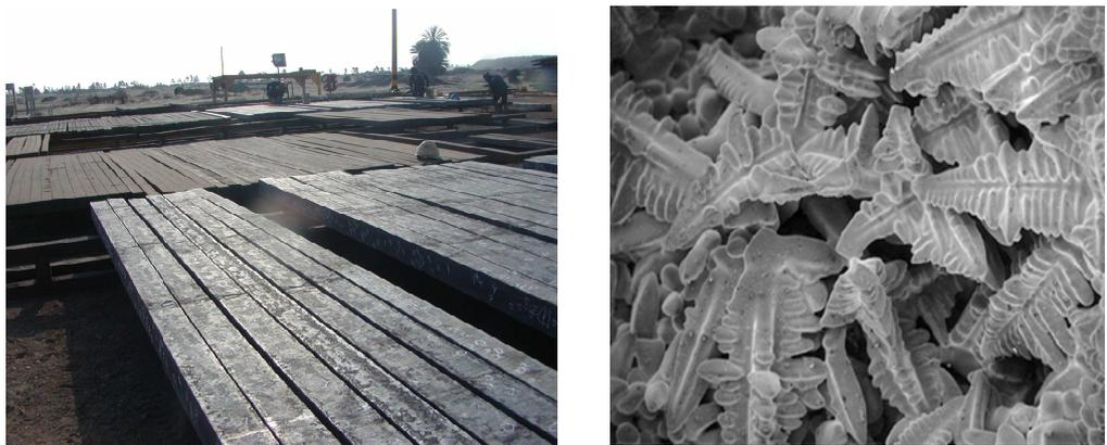
**Figura 1.41.** Lado izquierdo, Palanquillas de acero. Lado derecho, estructura interna dendrítica del acero.
