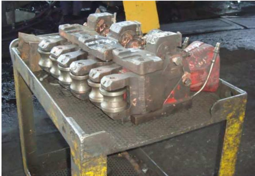
**Figura 3.3.** Guías de rodillos utilizadas en la prueba de laminación.
