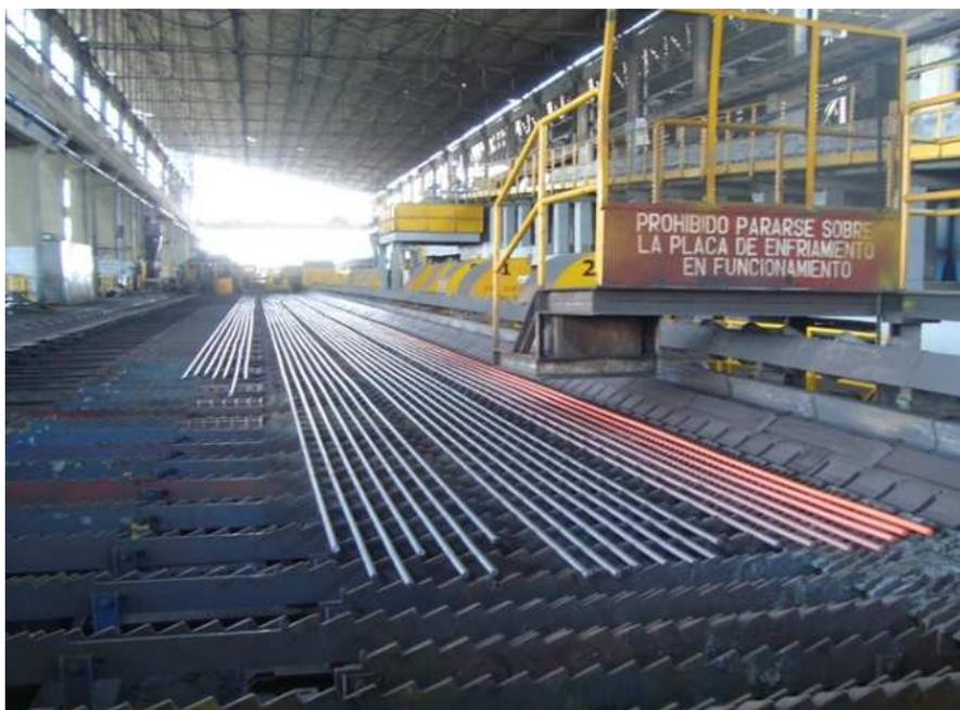
**Figura 1.186.** Placa de enfriamiento. Las barras se enfrían a medio ambiente.
