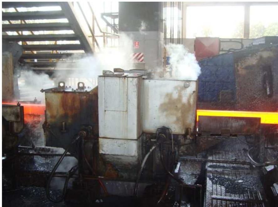
**Figura 3.5.** Uso del descascarillador.
