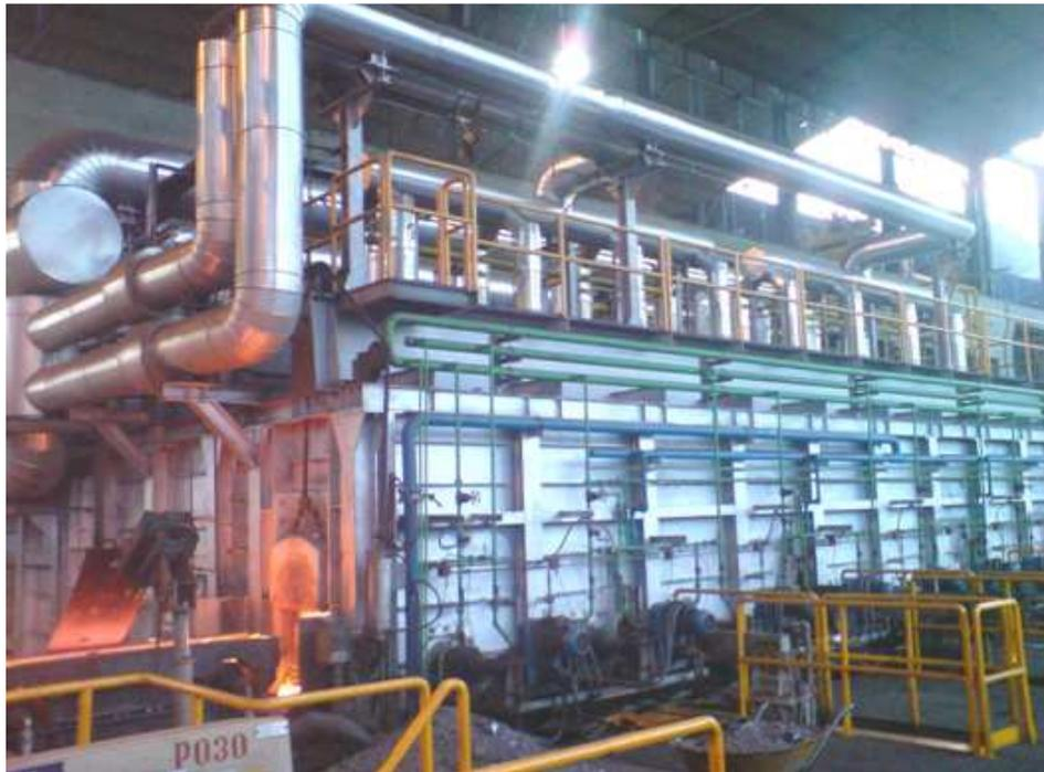
**Figura 1.12.** Horno de recalentamiento.
