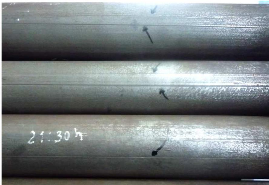
**Figura 3.6.** Ralladuras formadas en las primeras barras de prueba.
