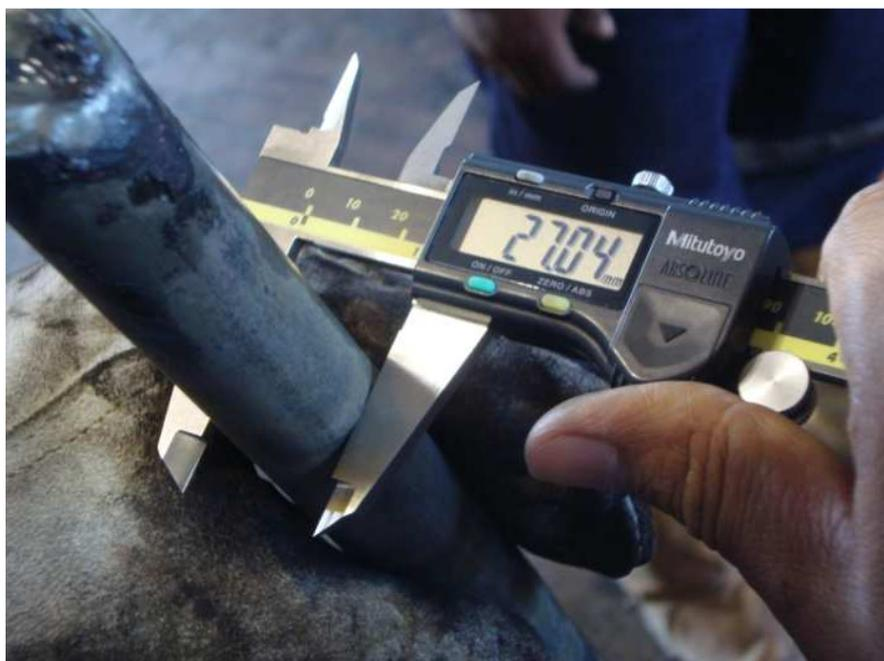
**Figura 3.4.** Inspección de medidas de una muestra de redondo liso  $\varnothing$  1-1/6".
