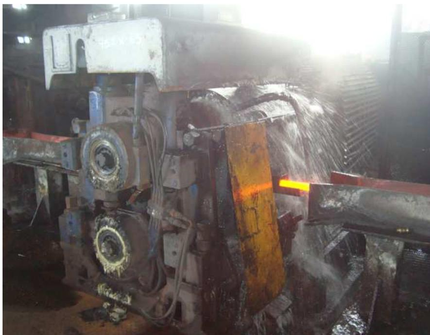
**Figura 3.2.** Laminación de la barra en la caja N° 9.
