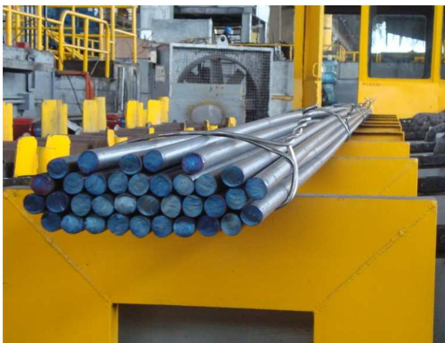
**Figura 1.19.** Paquete de Barras redondas lisas  $\varnothing$  1-1/16" calidad 1018
