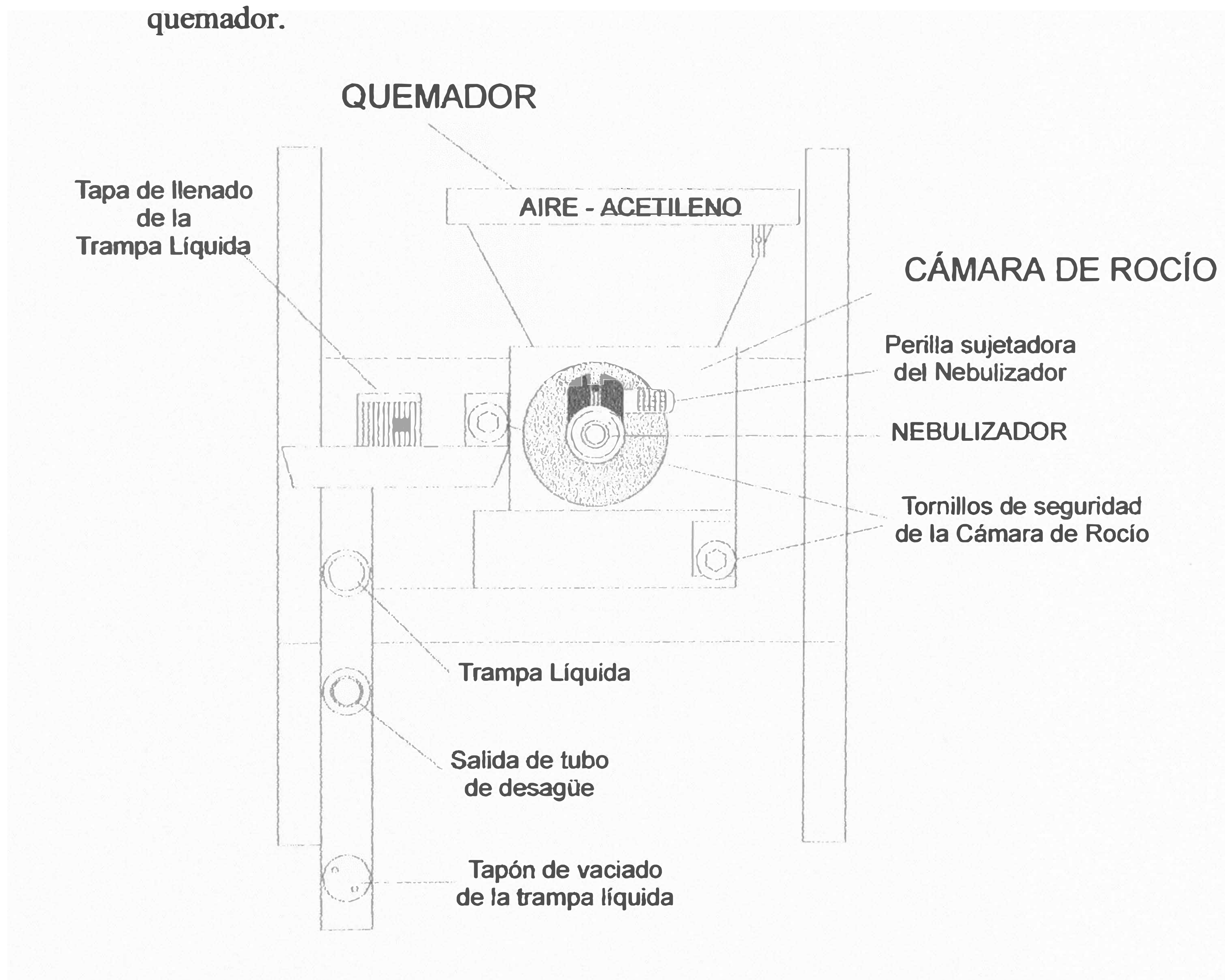
Figura: 2-11: Sistema de Atomización de la Llama del Avanta \Sigma
