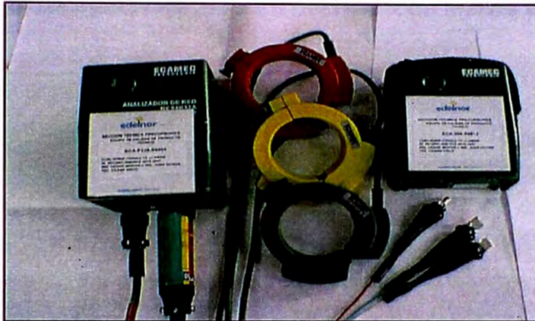
Fig. 4.7: Equipo Registrador Trifásicos de Baja Tensión Marca Ecamec
