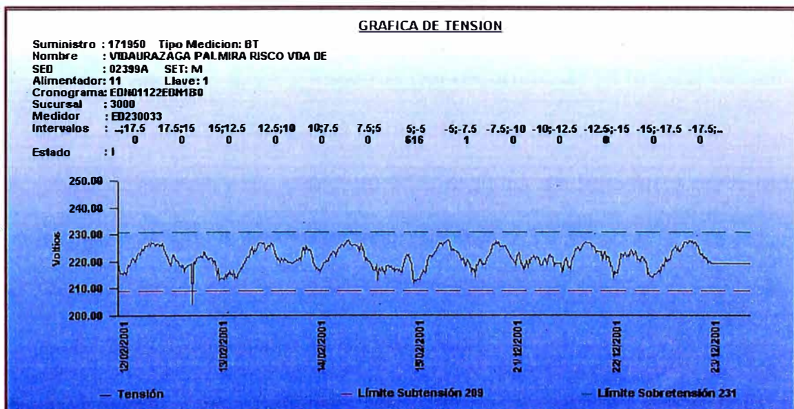
Gráfico 6.6: Comportamiento de la Tensión de una Medición Fallida de Baja Tensión
