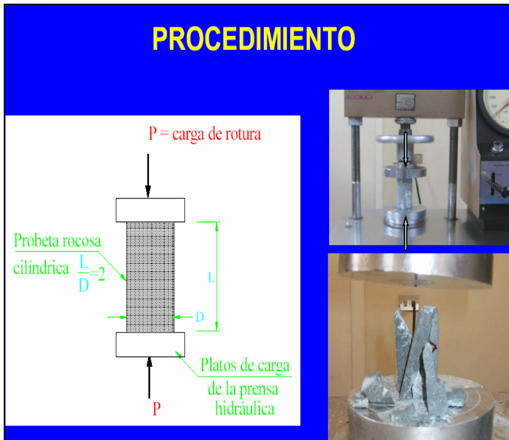
FIGURA 2 ENSAYO DE RESISTENCIA A LA COMPRESIÓN DE LA ROCA INTACTA SIMPLE UNIAXIAL LABORATORIO UNI
