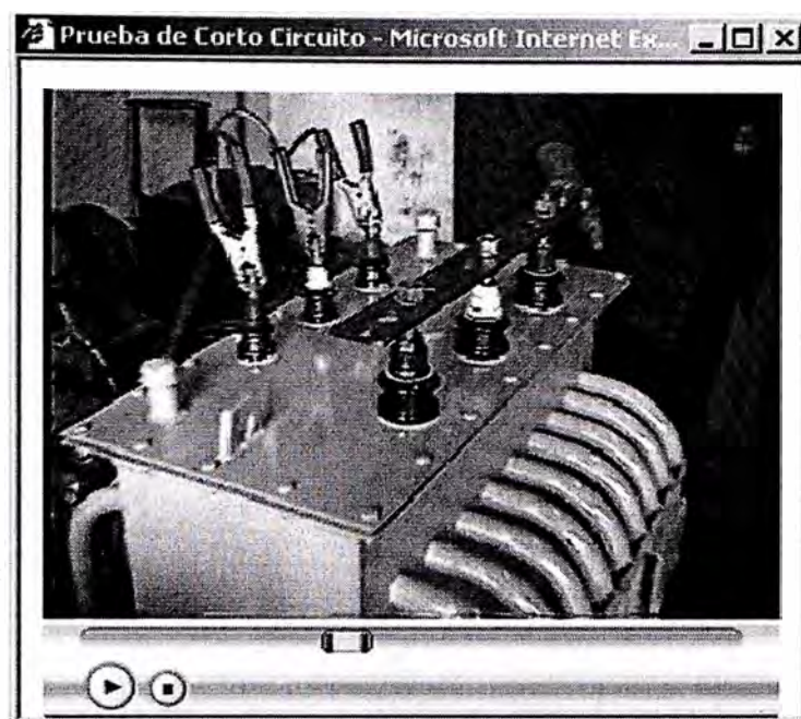
Pantalla 9: Pantalla que muestra el video de la prueba, en este caso se muestra el correspondiente a la prueba de corto circuito.
