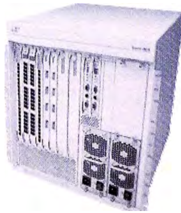
Figura 7.3 – Switch de core
