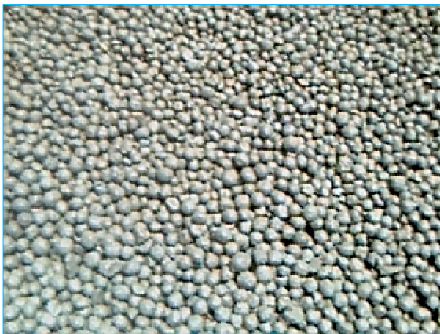
Figura N° 1.9: Hierro esponja (DRI), se compone de 86.98% Fe total, 76.41% Fe metálico, 87.77% grado de metalización, 0.15% S, 0.01% C, 0.02% Cu, 0.02% Zn y sus residuales 0.003% Cu, 0.004% Cr, 0.009% Ni y 0.006% Sn.
