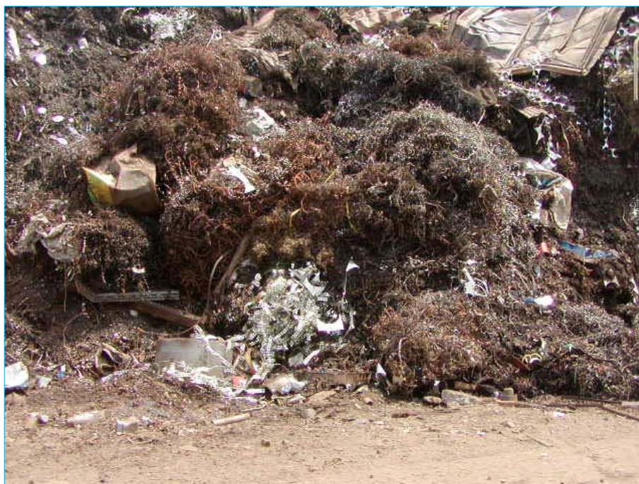
Figura N° 1.8: Viruta. Esta chatarra está constituida químicamente por: 0.4% C, 0.95% Mn, 0.20% Si, 0.040% P, 0.080% S, 0.40% Cr, 0.40% Ni, 0.01% Mo, 0.50% Cu y 0.045% Sn.
