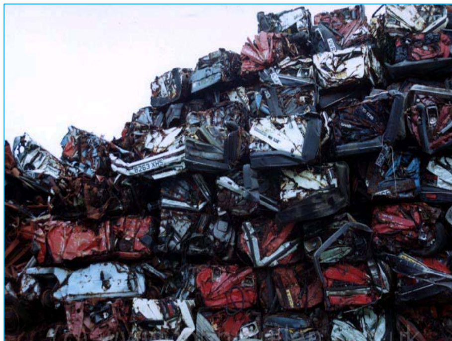
Figura N° 1.4: Chatarra automotriz compactada, está constituida por: 0.04% Cu, 0.20% Cr, 0.20% Ni y 0.100% Sn.
