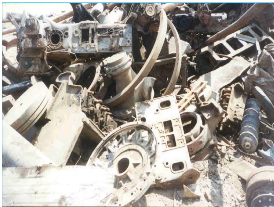
Figura N° 1.3: Chatarra de alto residual, está constituida químicamente por: 0.76% Mn, 0.42% Si, 0.044% P, 0.069% S, 0.46 Cr, 0.12 Ni, 0.03% Mo, 0.33% Cu y 0.024% Sn.
