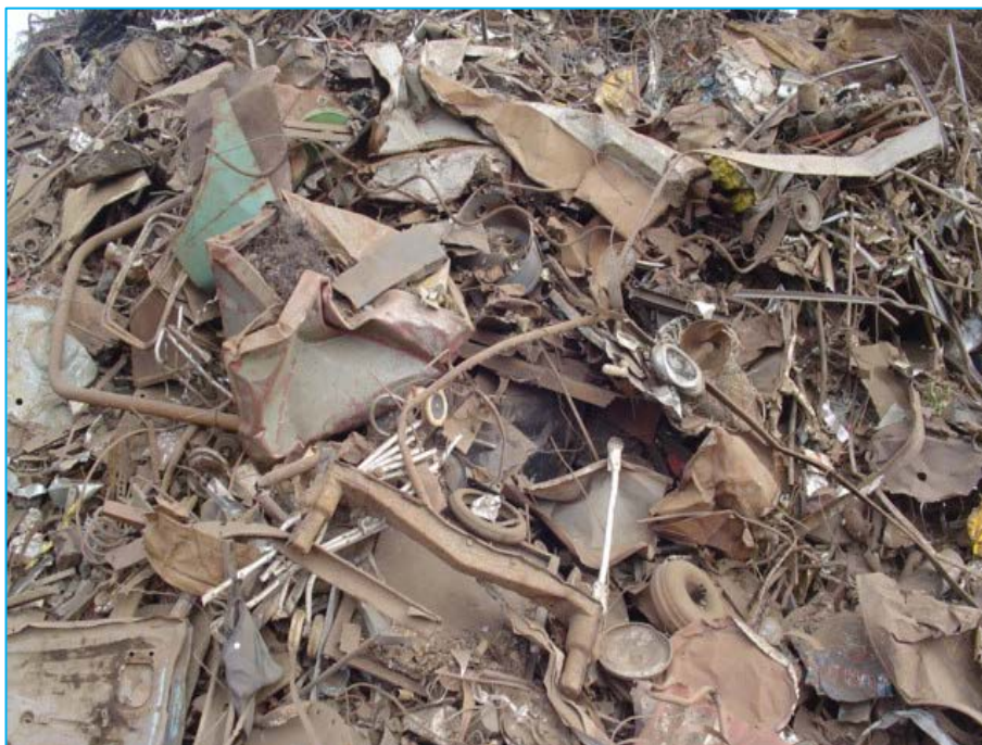
Figura N° 1.5: Electrodomésticos obsoletos, su composición química es: 0.10% Cu, 0.05% Cr, 0.03% Ni y 0.080% Sn.
