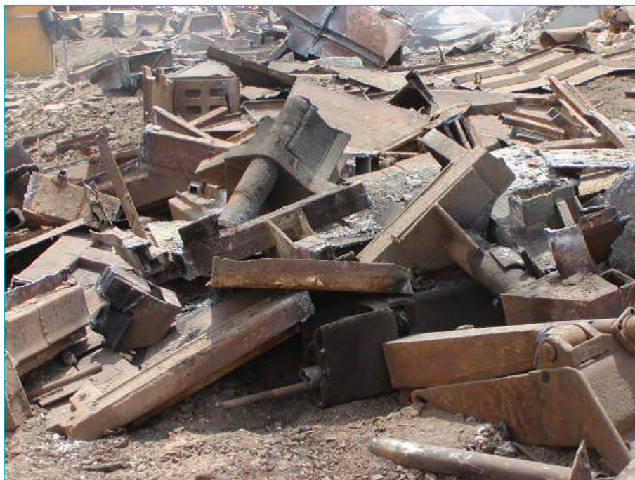
Figura N° 1.1: Recortes de estructuras, esta chatarra posee elementos como: 0.30% Cu, 0.20% Cr, 0.20% Ni y 0.020% Sn.
