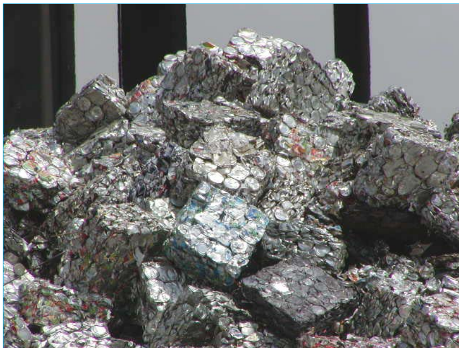
Figura N° 1.7: Latas de conservas compactadas. Esta chatarra químicamente está constituida por: 0.08% C, 0.50% Mn, 0.08% Si, 0.018% P, 0.027% S, 0.03% Cr, 0.03% Ni, 0.01% Mo, 0.03% Cu y 0.35% Sn.
