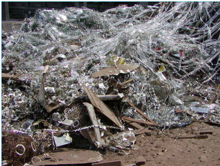
Figura N° 1.6: Recortes industriales (fabricación de chapas). Esta chatarra está constituida químicamente por: 0.07% C, 0.55% Mn, 0.07% Si, 0.016% P, 0.025% S, 0.03% Cr, 0.03% Ni, 0.01% Mo, 0.03% Cu y 0.025% Sn.
