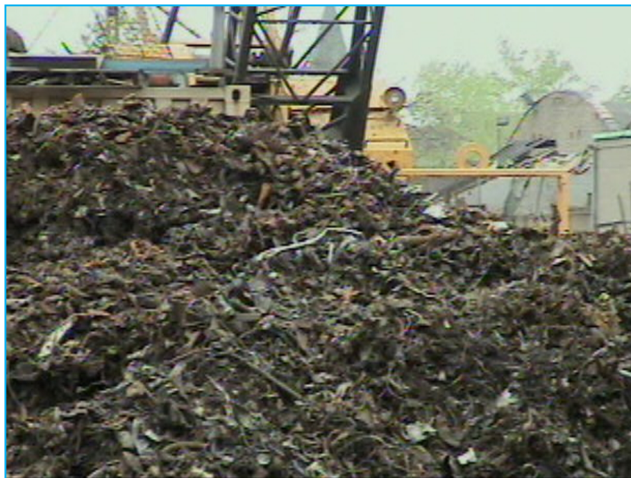
Figura 1.11: Chatarra fragmentada (posee una densidad mayor a 0.8t/m^3 ), está constituida químicamente por: 0.25% Cu, 0.30% Cr, 0.036% Ni y 0.05% Sn.
