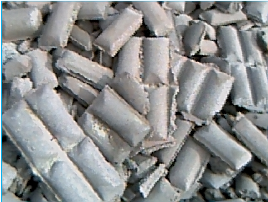
Figura N° 1.12: Briquetas, químicamente esta compuestos por 0.003%Cu, 0.004%Cr, 0.009% Ni y 0.006%Sn.
