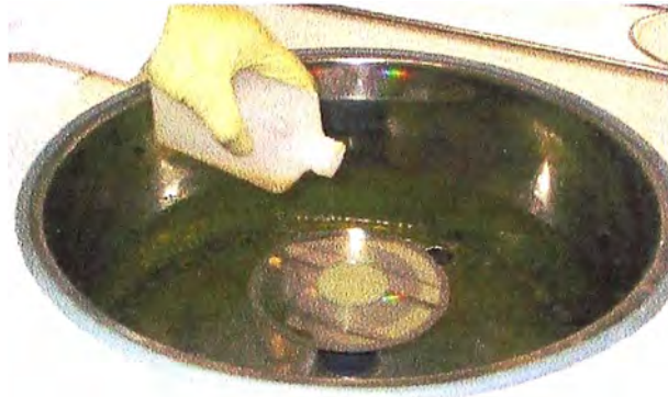
Fig. 41: Aplicación de la laca de protección (Ercopell)
