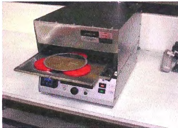
Fig. 39: Limpieza del stamper por luz UV y ozono.
