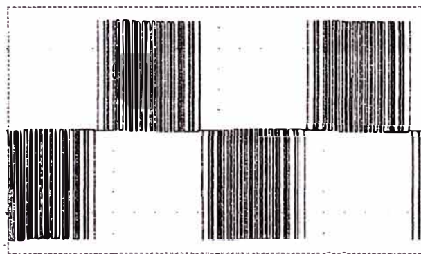
Figura 2.3. Tensión de Línea del Inversor (PWM)
