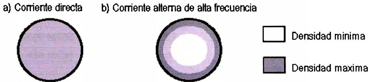
Figura No. 2.9. Densidades de corriente en un mismo conductor (a) a corriente directa y (b) a corriente de alta frecuencia.
