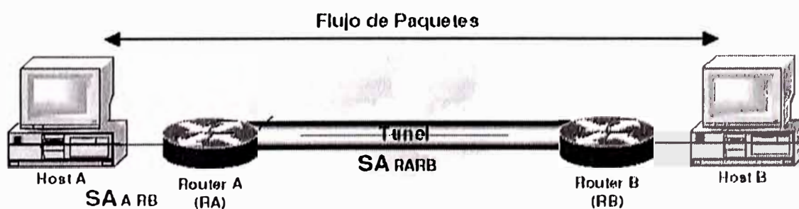
Figura 3.4 Aplicación de IPsec en modo túnel
