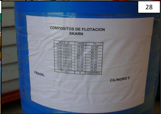
Fotos: 23. Embalaje de muestras para pruebas de molienda, 24. Caja con muestras para enviar, 25. Muestra para prueba de flotación (Intrusivo), 26. Muestra para prueba de molienda, siendo pesada en balanza, 27. Sellado de muestra al calor, 28. Cilindro con muestras para flotación para enviar.
