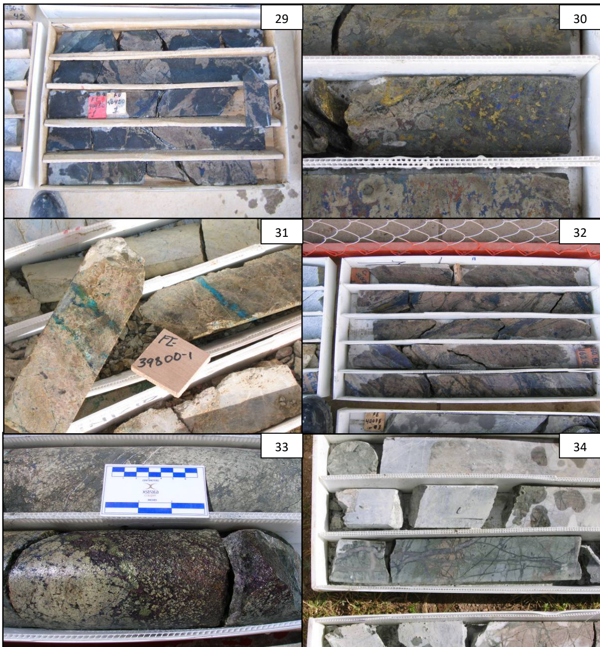
Fotos: 29. Skarn de granate con bornita masiva, 30. Skarn de granate con calcopirita y bornita en coágulos y diseminaciones, 31. Skarn de granate con óxidos de Cu, 32. Skarn de granate con vetillas cuarzo-calcopirita-bornita, 33. Coágulos de bornita crecidos en espacios intersticiales dentro de granates de grano grueso, 34. Skarn de piroxenos (verde claro) con venillas milimétricas de cuarzo (+sulfuros) cortándolo.
