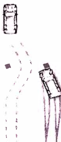
figura 1. Efecto de frenado brusco con y sin ABS
