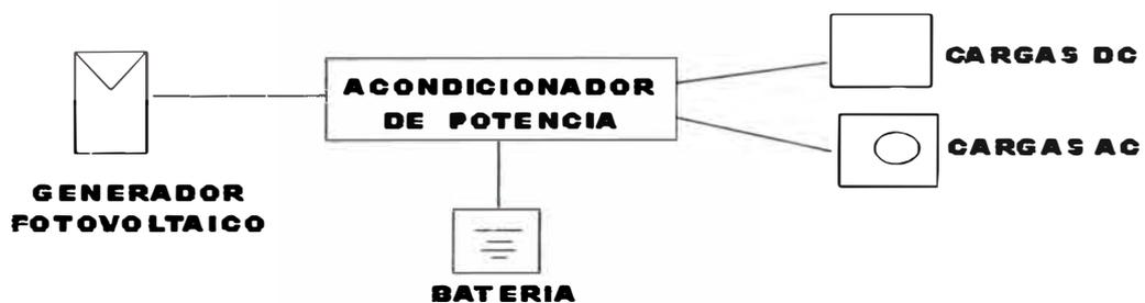
Describiremos brevemente los componentes de un Sistema Fotovoltaico (SFV):
