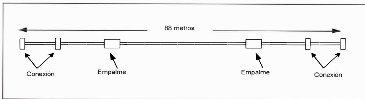
Figura 3-22 Enlace de una Fibra Óptica típica.
