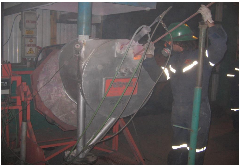
Foto 3. Operación de soplado de oxígeno en el horno TBRC
