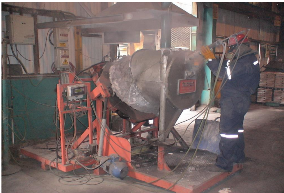
Foto 2. Operación del horno TBRC
