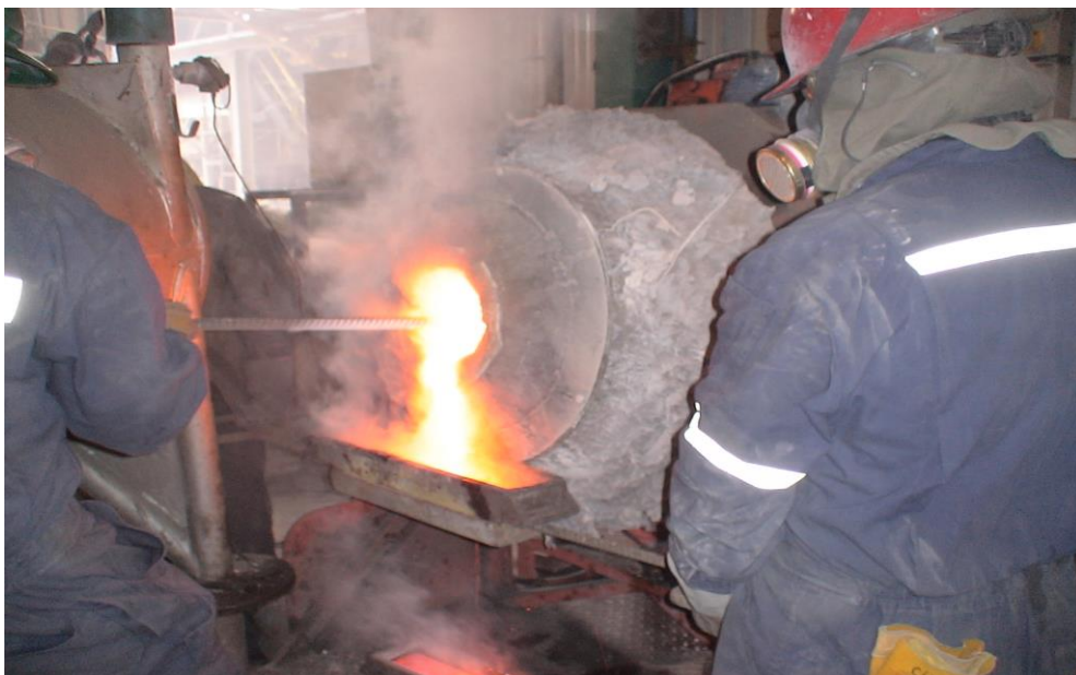
Foto 4. Operación de escoriado en el horno TBRC
